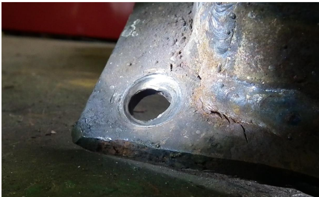
8. ábra: a lemez sarka a megkopott csavarfurattal
