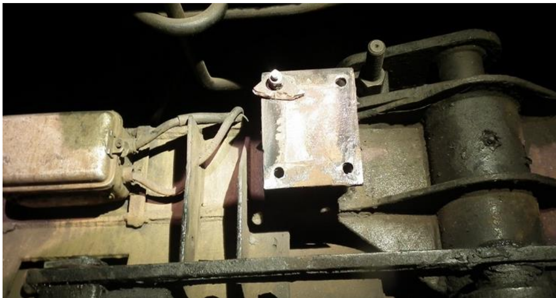
7. ábra: a pályakotró jobb konzolja, törött lemezzdarabbal
