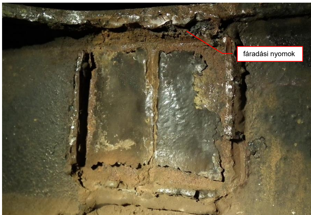
6. ábra: a bal konzol eltört hegesztése
