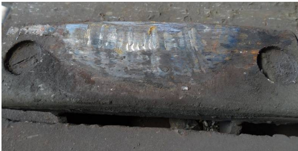
6. ábra: az első forgóváz jobb oldali csúszótámja
