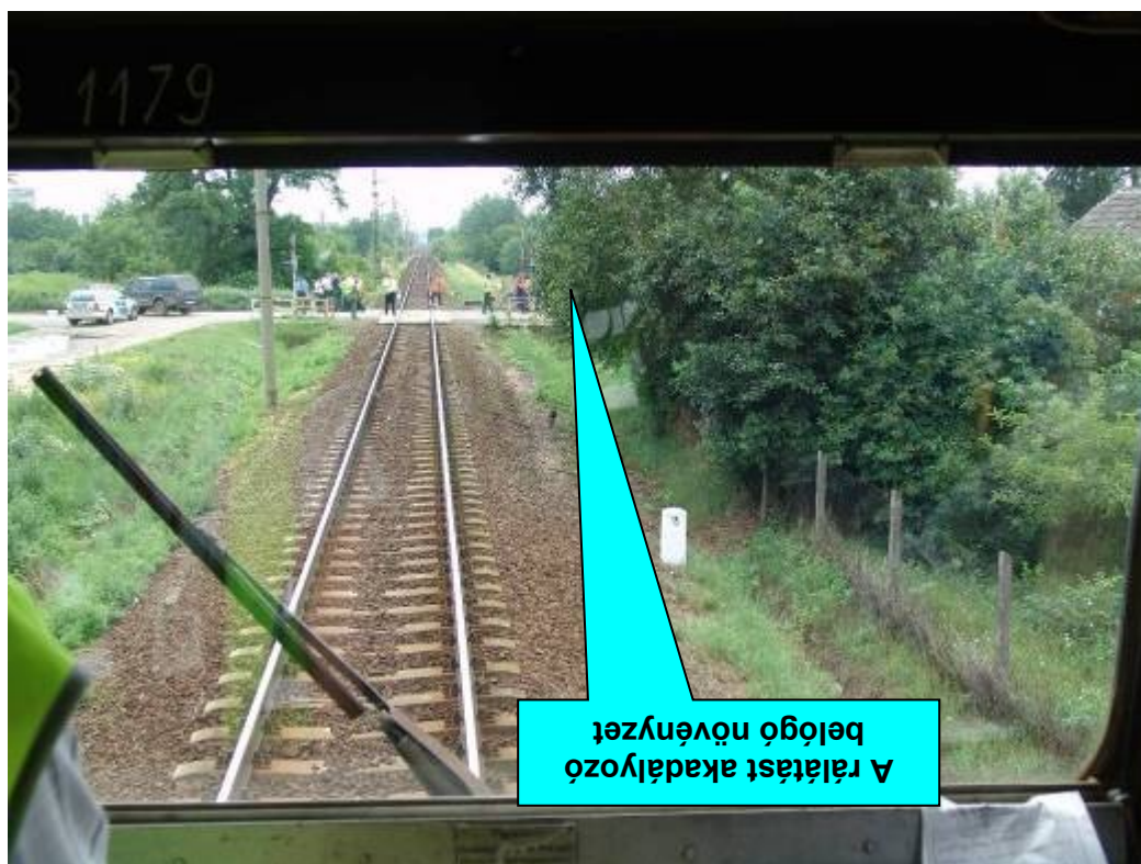
13. ábra: Rálátás az AS15 számú útátjáróra a V43-1179 pályaszámú mozdony vezetőállásából kb. 45 méter távolságból
