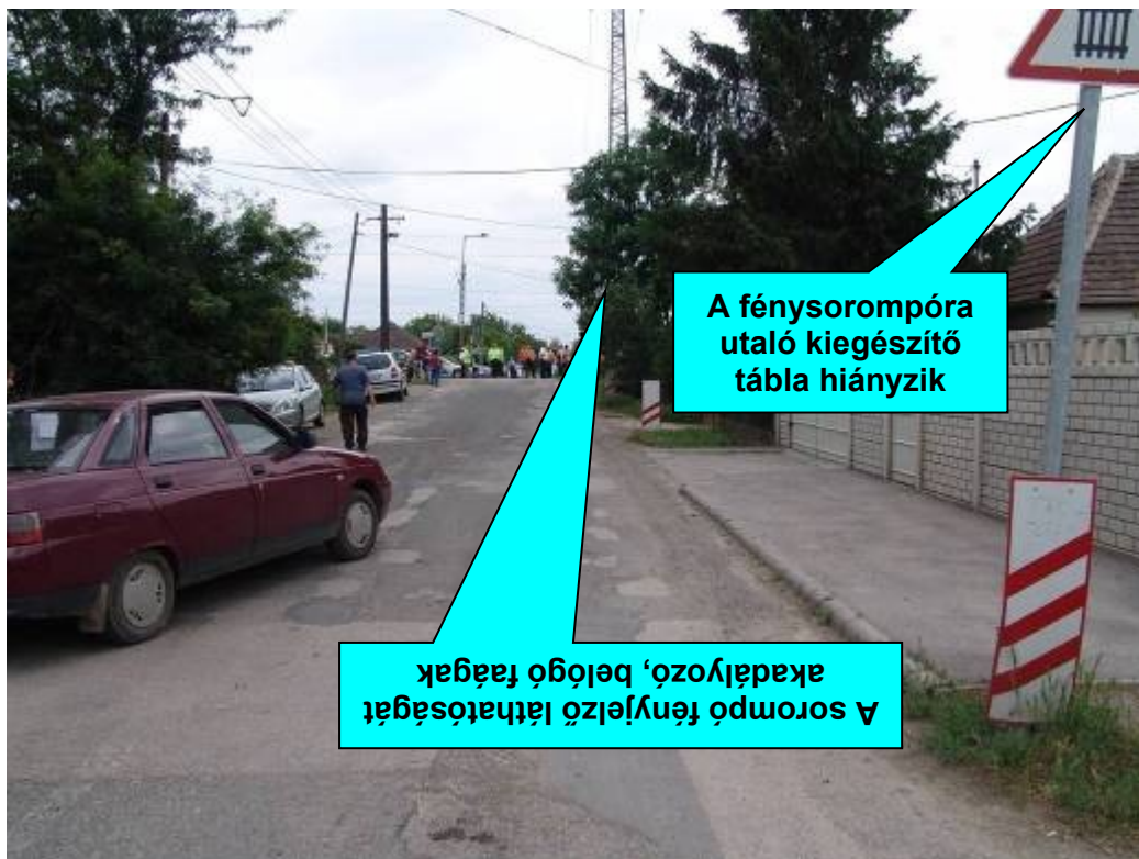
8. ábra: Az AS15 számú átjáró láthatósága és kitáblázása a közút felől
