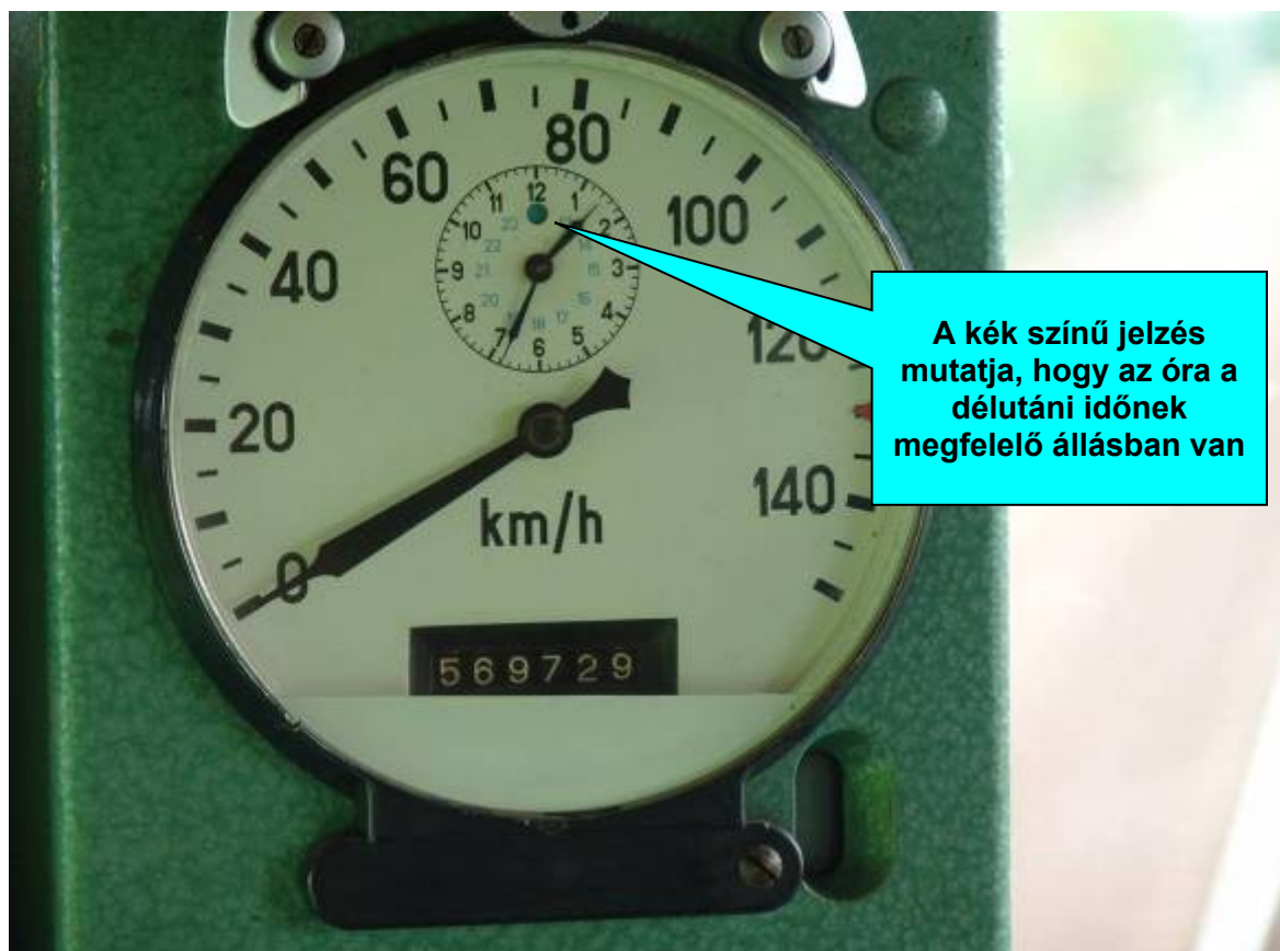
11. ábra: A V43-1179 psz. mozdony sebességmérő órája (150 km/h)
