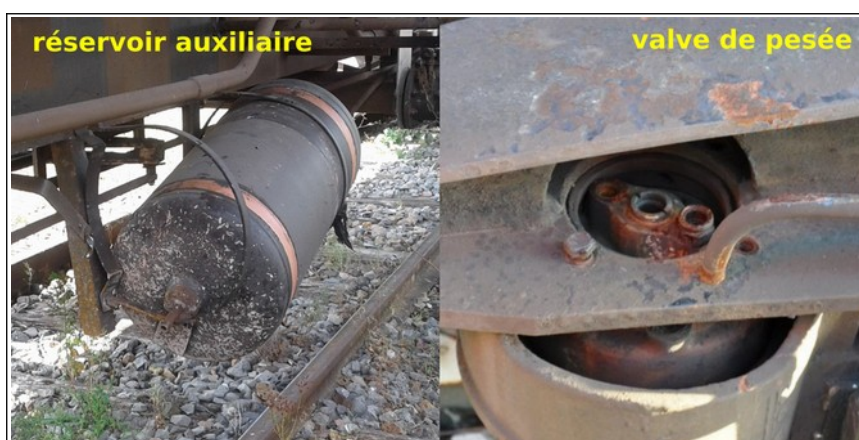
Figure 34 : le réservoir auxiliaire et la valve de pesée
