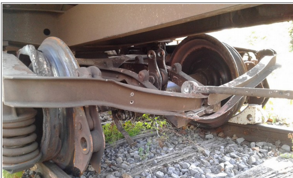
Figure 28 : vue de la timonerie et du cadre du bogie 2 vu de l'arrière
