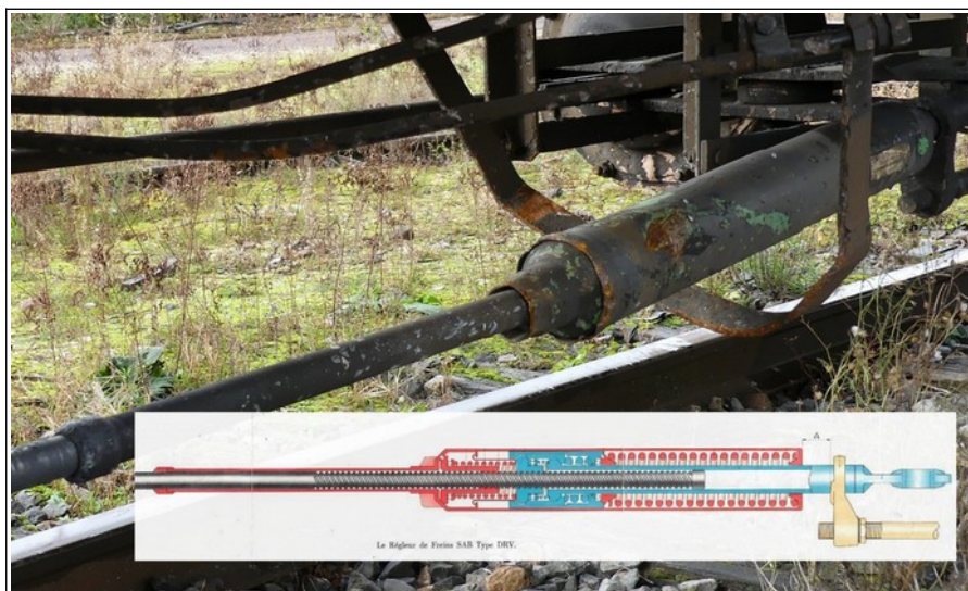
Figure 33 : vu des chocs sur le régleur et schéma en coupe
