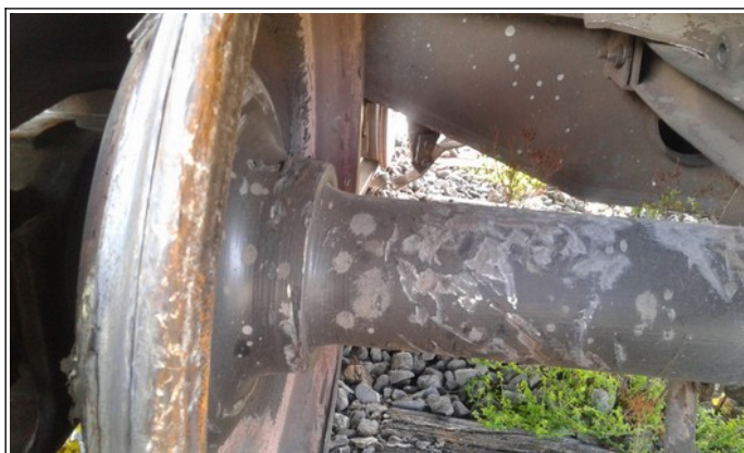
Figure 31 : exemple d'impacts en sous-face du wagon
