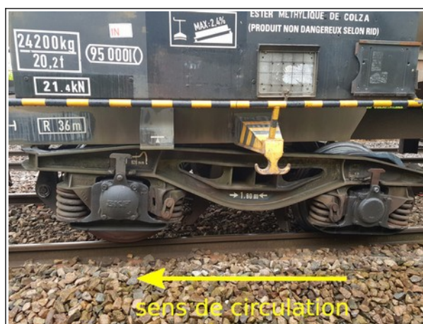
Figure 2 : le bogie avarié à l'avant du 4 e wagon
