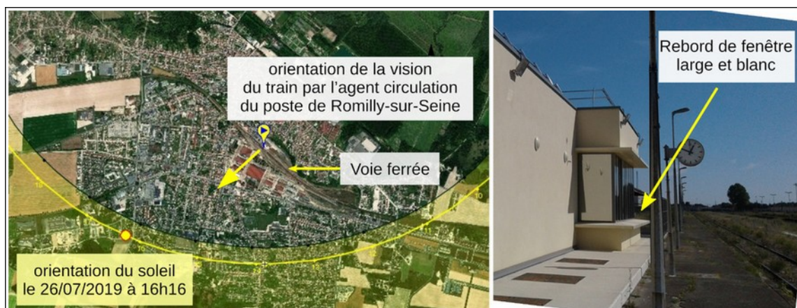
Figure 18 : orientation du soleil et vue du poste de Romilly-sur-Seine
