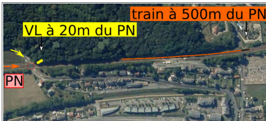
Figure 23 : position finale du VL et du TER après le choc (vue aérienne Géoportail-IGN, légende BEA-TT)
