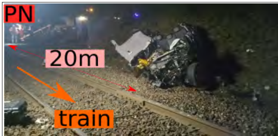
Figure 22 : position finale du VL par rapport au passage à niveau (photo SNCF, légende BEA-TT)
