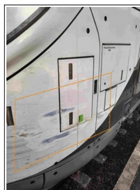
Figure 14 : photos de la motrice après la collision. (source conducteur du train – SNCF, modifiées par le BEA-TT)
