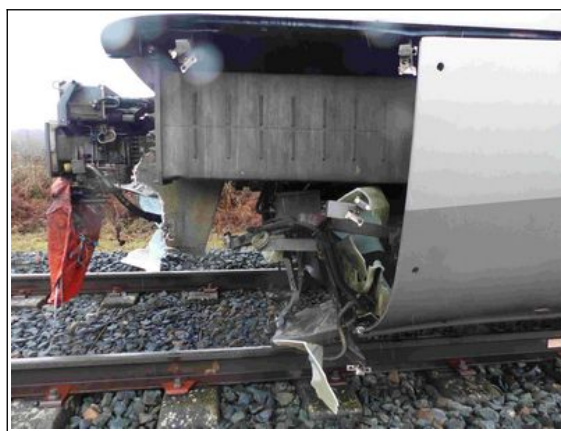
« Les tampons sont légèrement déformés de chaque côté »
