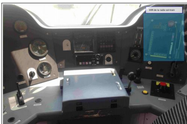
Figure 45 : exemple de localisation de l'interface homme-machine de la radio sol-train source BEA-TT
