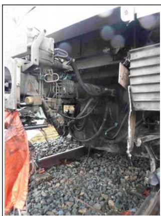
« L'attelage automatique est cassé et fendu sous la corne de guidage »
