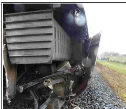
« Les éléments de carénage sont fendus et pendent de chaque côté de la rame »
