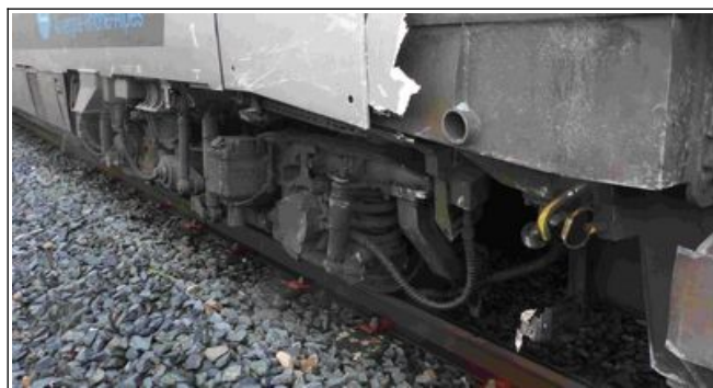
« Sur le côté droit un amortisseur hydraulique longitudinal a été touché et plié »
