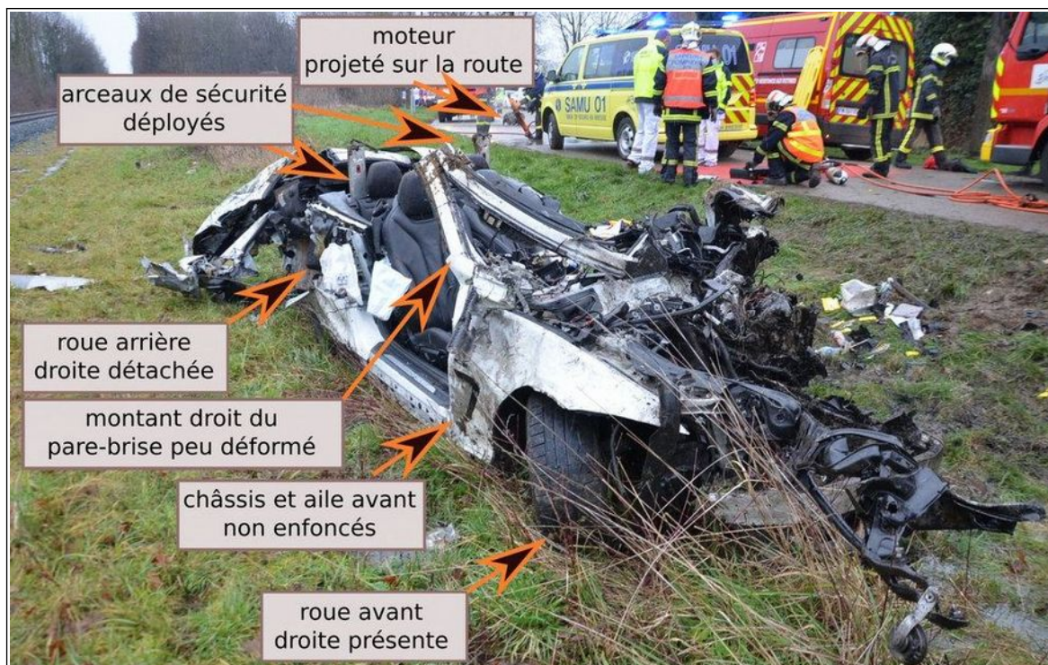
Figure 21 : côté droit du véhicule après les opérations de désincarcération de la victime photo Police nationale, légendée BEA-TT
