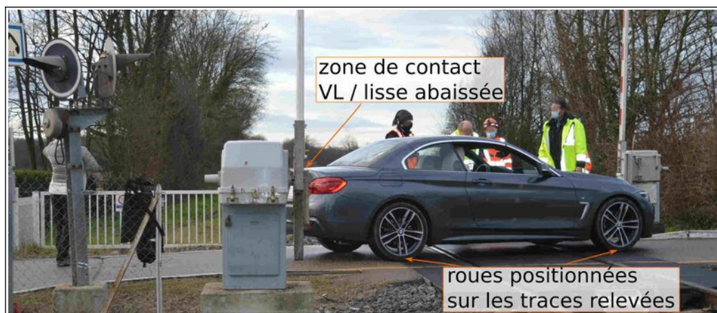
Figure 35 : photo de l'appréciation du point de contact entre la lisse abaissée et le VL photo Police nationale légendée BEA-TT
