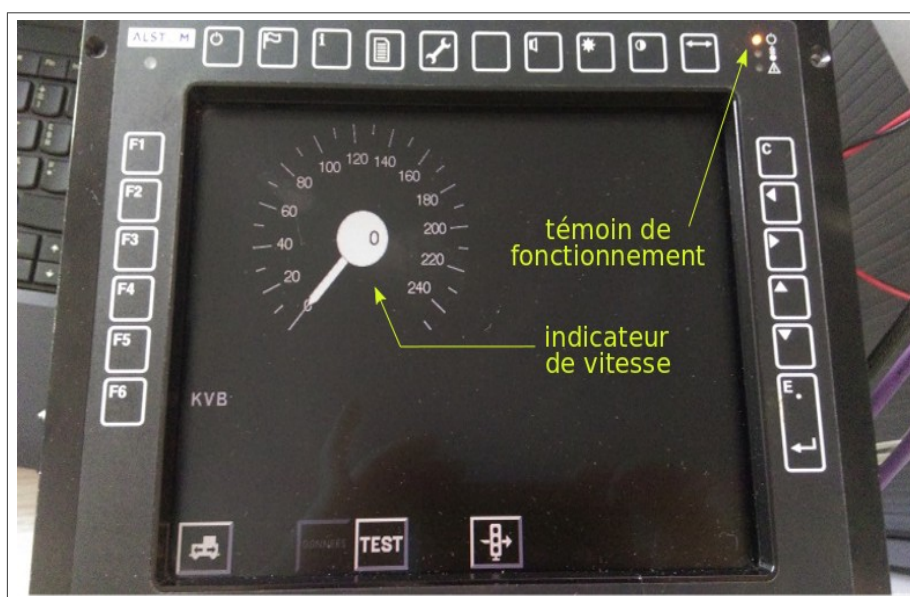
Vue n° 7 : l'affichage KVB sur DMI type ERTMS
