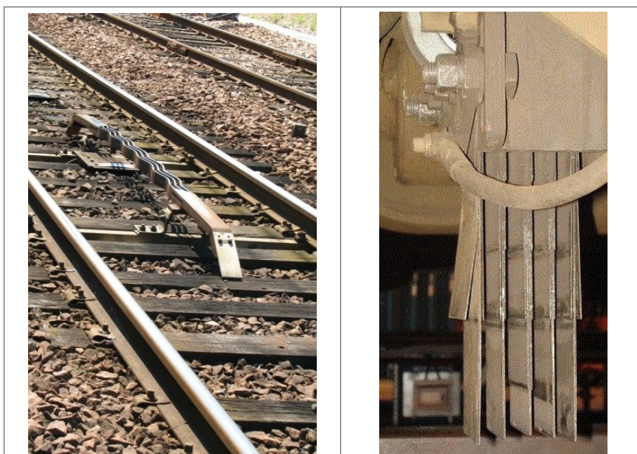
Vue n° 9 : à gauche un crocodile ; à droite une brosse sous une locomotive
