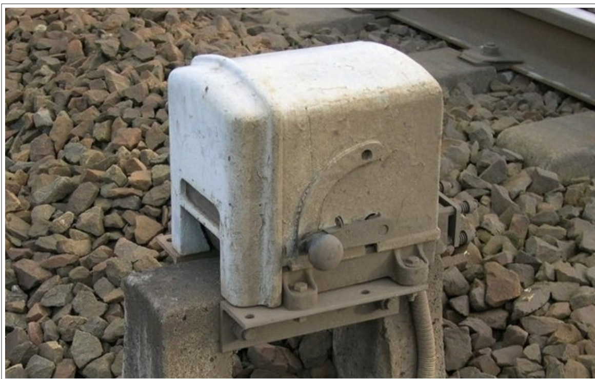
Vue n° 10 : le boîtier d'un détonateur de carré
