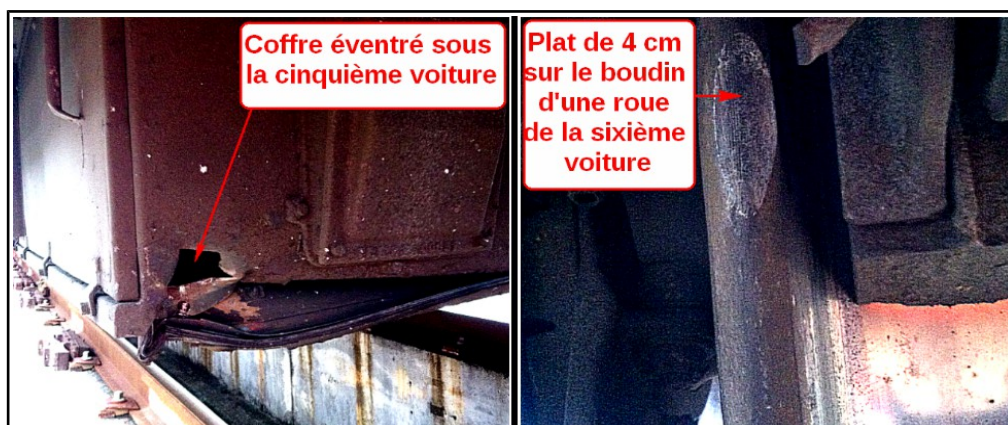
Fig. 9 : Exemples d'avaries constatées sous les voitures du train n° 4053
