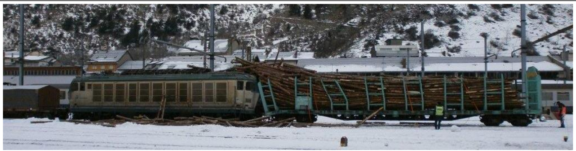
Figure 2 : Vue d'ensemble montrant les rondins projetés par le choc
