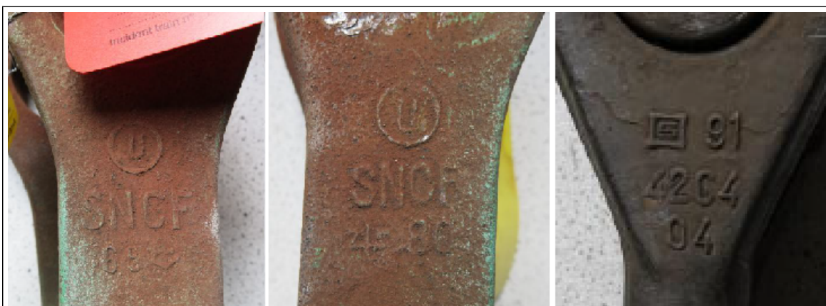
Figure 12 : Marquages des bielles et de la manille
