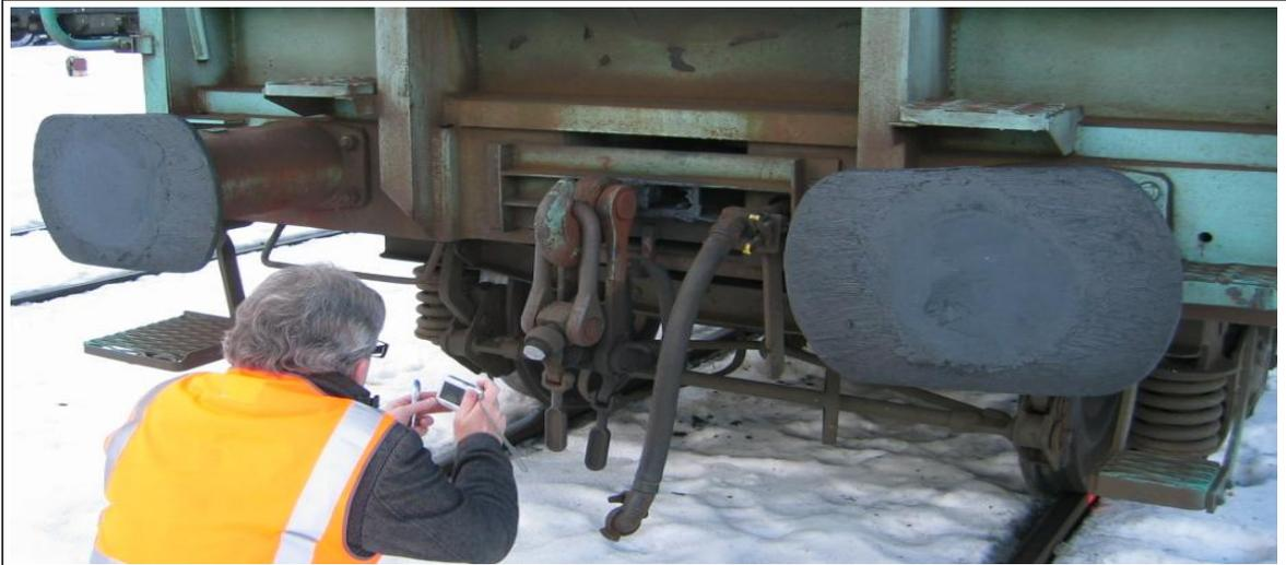
Figure 4 : Vue de la traverse avant du wagon accidenté.
