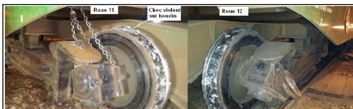
Figure 24 : Dommages sur l'essieu 11-12
