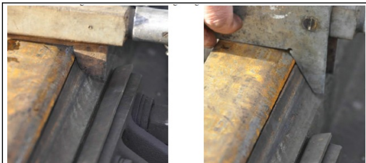
Figure 35 : Vérification avec calibre le n° 2 et avec le gabarit de meulage
