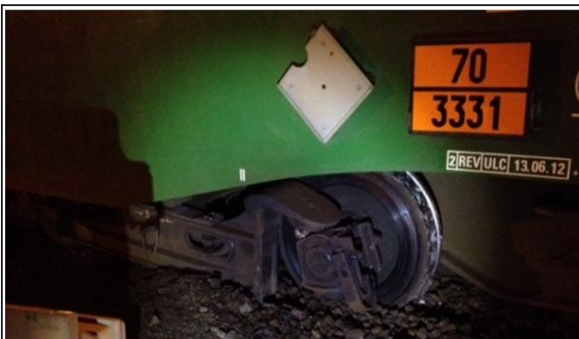
Figure 3 : Gros plan sur les codes matières dangereuses portés par le wagon – Code danger 70 : radioactivité – Code matière 3331 : matières radioactives fissiles transportées sous arrangement spécial
