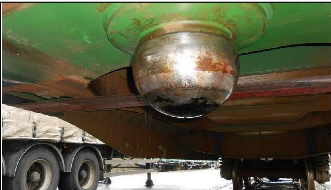
Figure 26 : Rotule arrière du châssis principal
