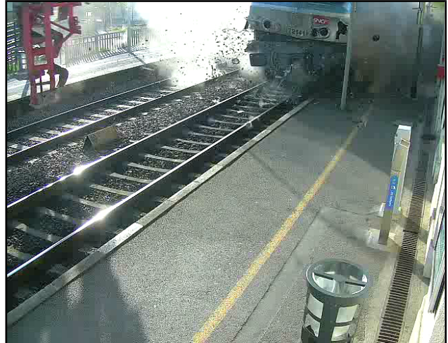
Figure 38 : À T0+0'03'' le train qui a déraillé, grimpe sur le quai.
