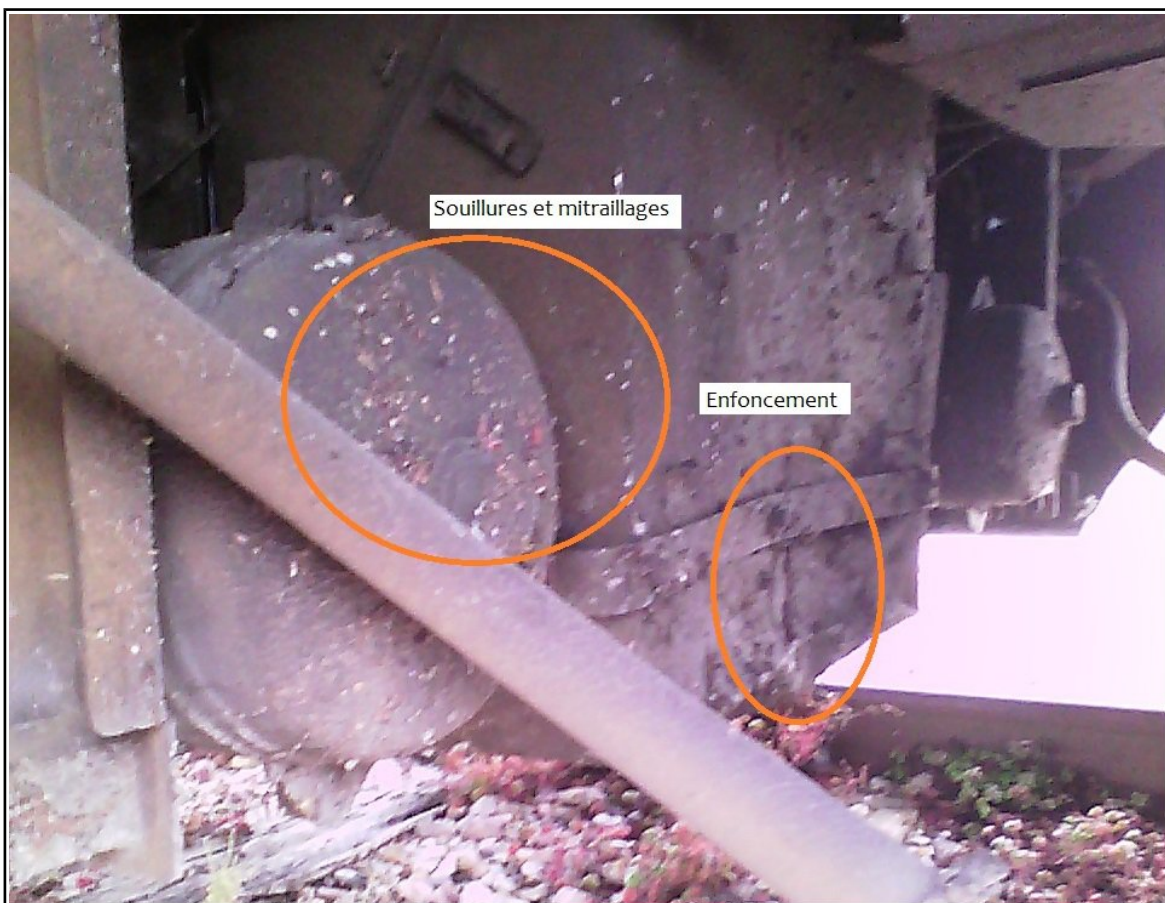
Figure 10 : Enfoncements, souillures et mitraillages des organes sous-caisse
