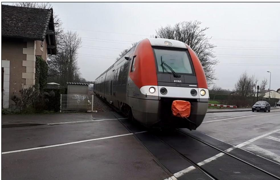
*Figure 17 : Vue d'un autorail bimode type B 81500 4C sur le PN n°19*
