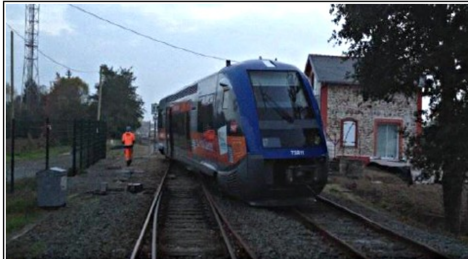
Figure 1 : Arrière de l'autorail X 73811 déraillé
