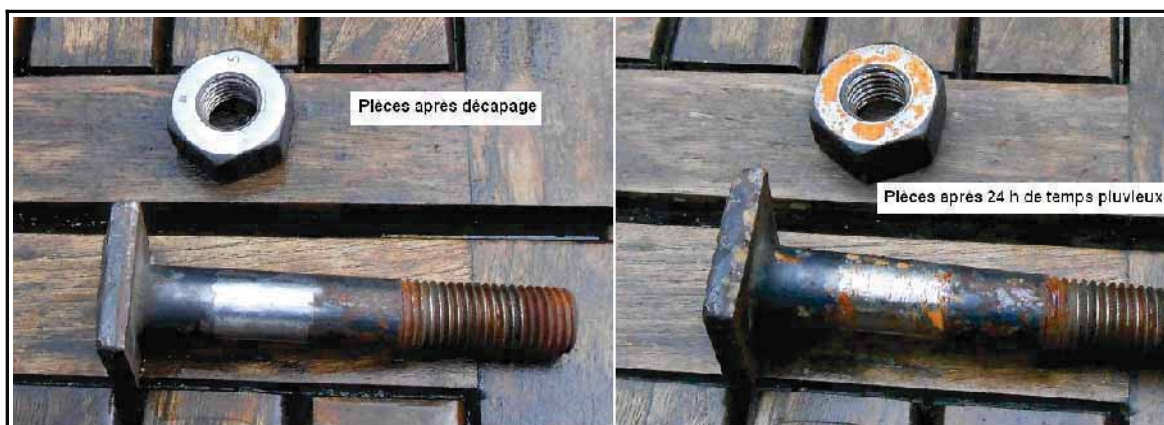
Figure 43 : Effet de la pluie sur des pièces de boulonnerie décapées
