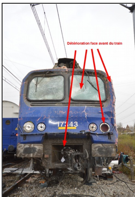
Figure 17 : État de l'avant de la rame de tête du train après l'accident
