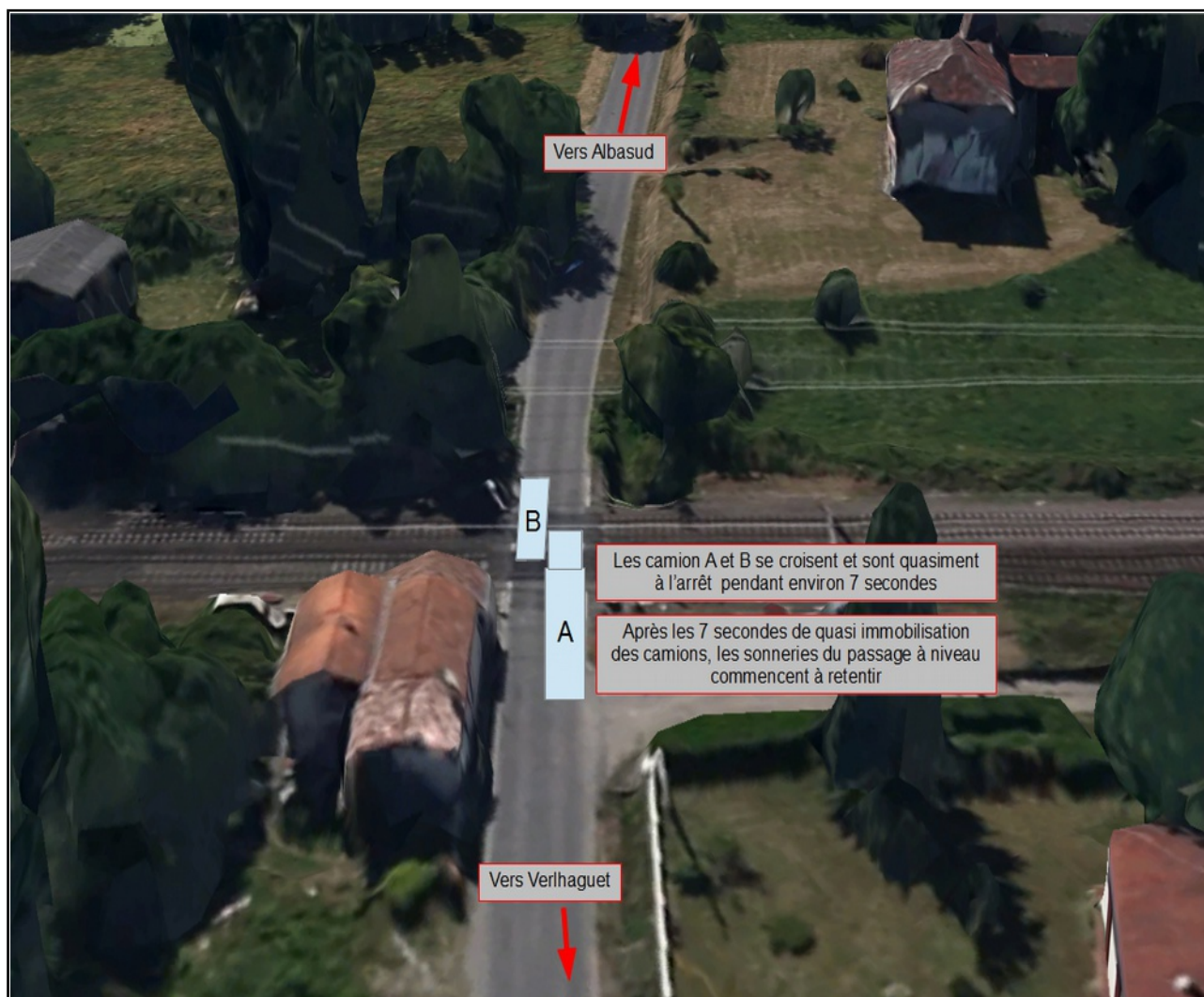
Figure 29 : Quasi immobilisation des camions lors de leur croisement sur le passage à niveau puis début de déclenchement des sonneries
