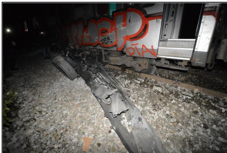
Figure 12 : Partie du châssis du camion sous la rame avant du TER
