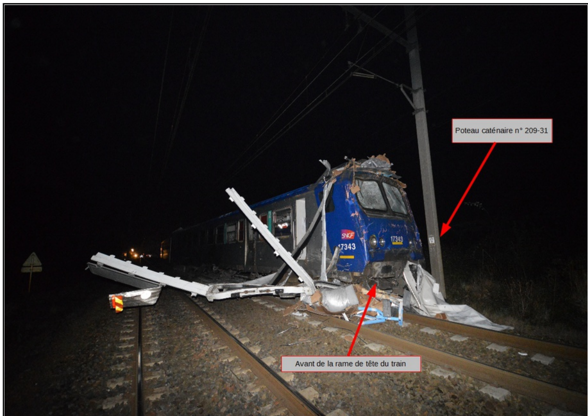
Figure 9 : Position finale de la rame de tête du train après la collision
