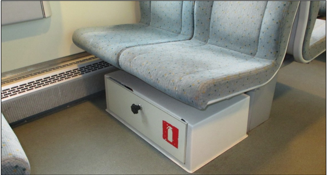
Kuva 7. Jauhesammuttimien sijoitus Dm12-kiskobussin istuinpenkkien alla. (Kuva: OTKES)
