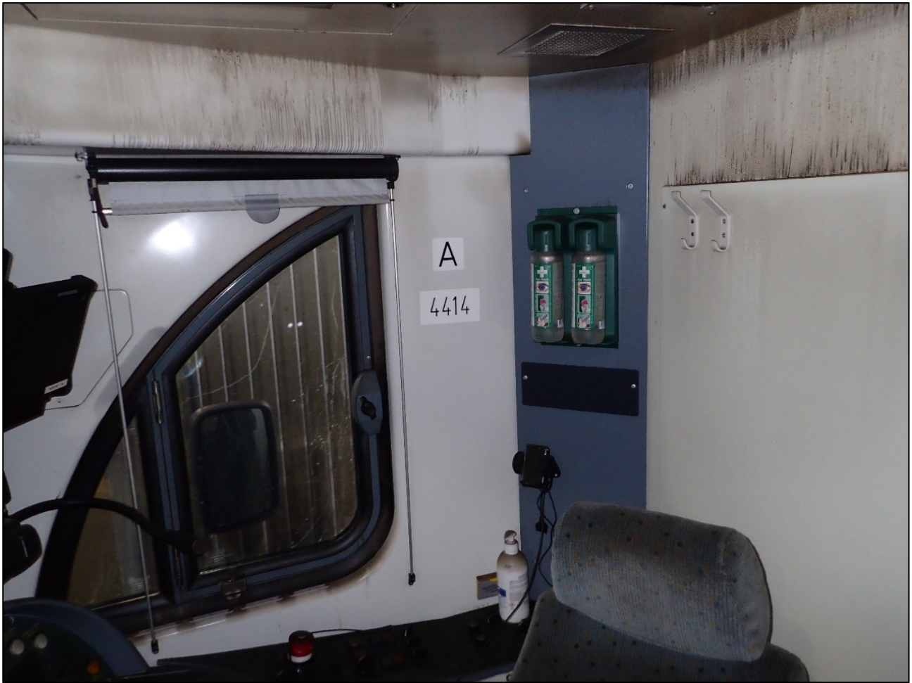
Kuva 4. Savun aiheuttamia vahinkoja oli havaittavissa Dm12-kiskobussin A-pään ohjaamossa saakka. (Kuva: OTKES)
