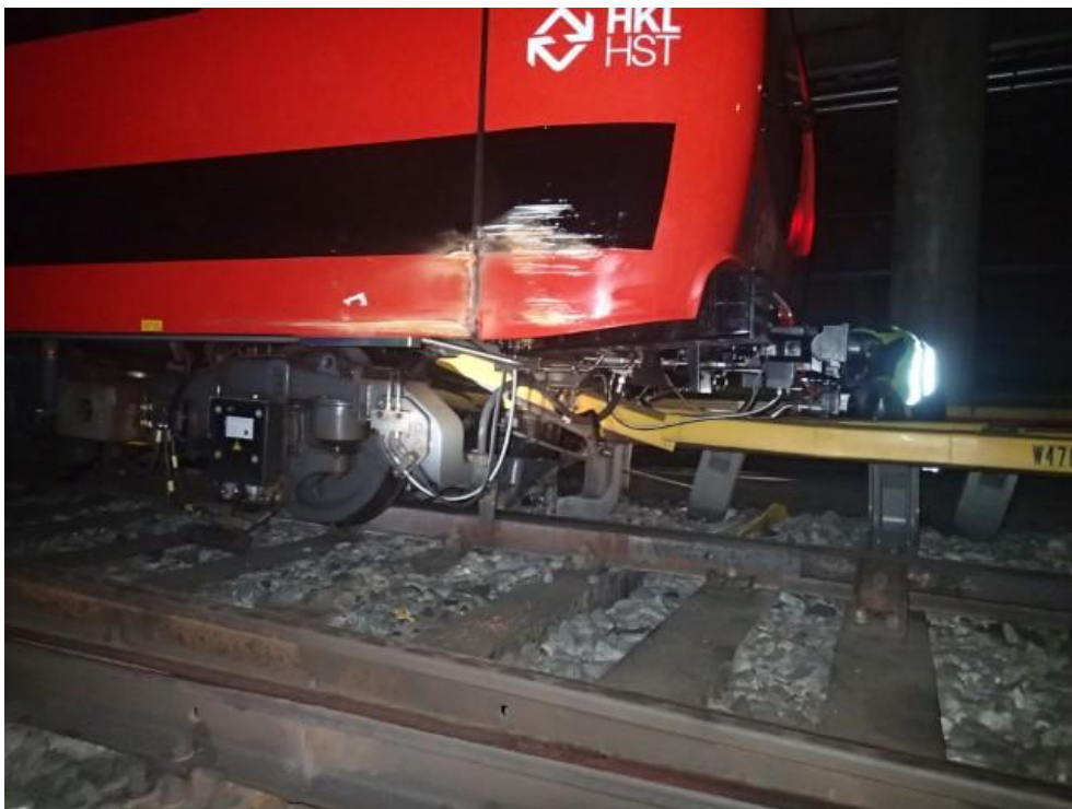
Kuva 10. Virtakisko tunkeutui koeajojunan lattiarakenteiden läpi. (Kuva: OTKES)
