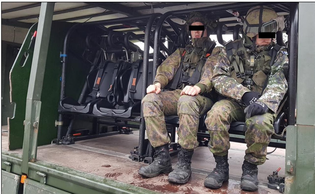
Kuva 15. Kuormatilaistuinilla istutaan tiiviisti vierekkäin. (Kuva: OTKES)
