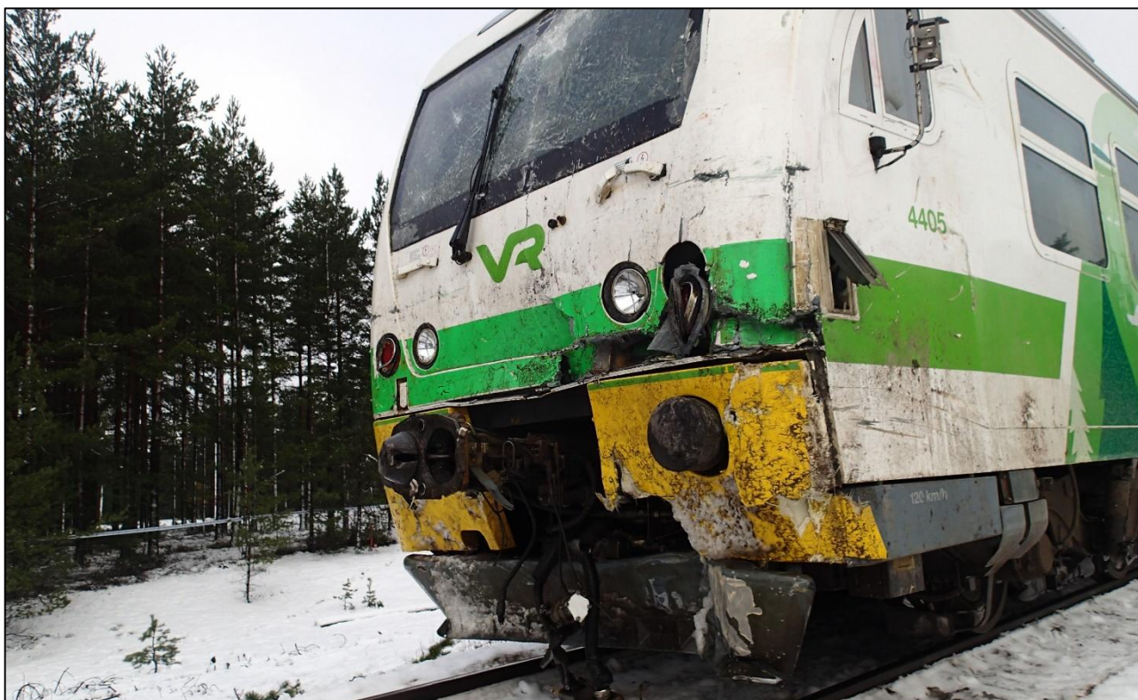
Kuva 9. Kiskobussin keulan vauriot. (Kuva: OTKES)
