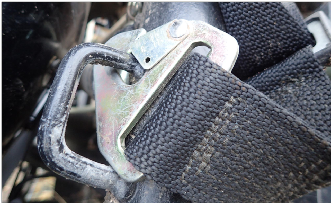
Kuva 12. Maastokuorma-auton kuormatilaistuintien turvavöiden kiinnitykset tarkastettiin ja ne olivat kunnossa. (Kuva: OTKES)
