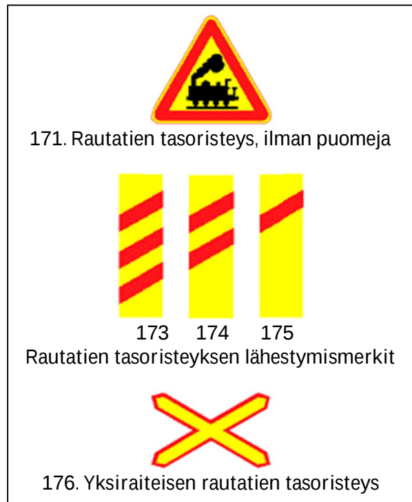
Kuva 13. Määräysten mukaiset liikennemerkkit Skogbyn tasoristeykseen. Ylin merkki puuttui risteyksestä. (Kuva: tieliikennelain liitteet)
