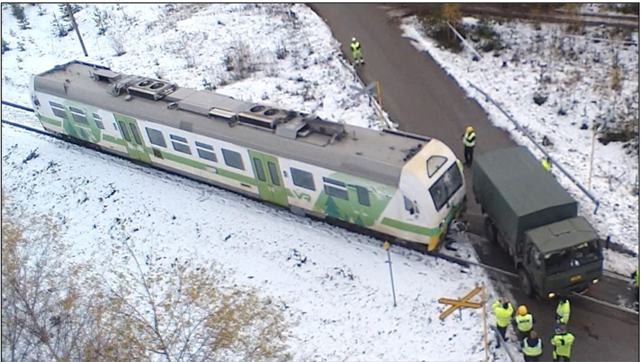
Kuva 2. Kiskobussin vasen etukulma törmäsi maastokuorma-autoon oikean takapyörän kohdalle. Kuva rekonstruktioista onnettomuuspaikalla. (Kuva: OTKES)
