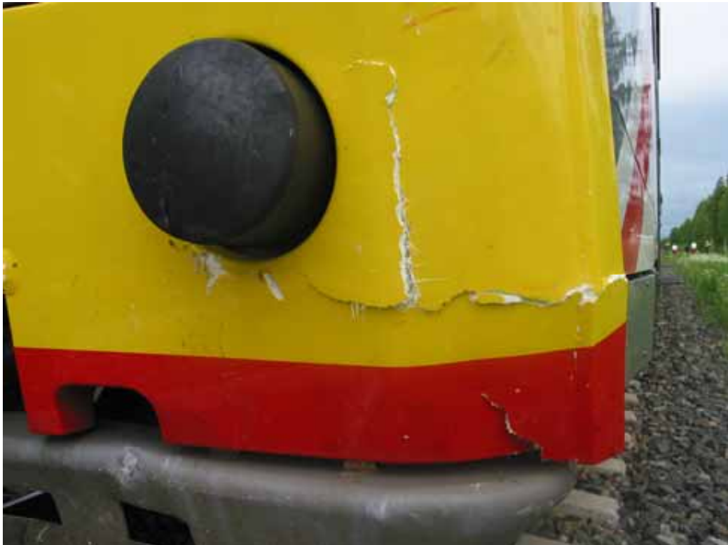
Kuva 2. Junan vasemman etukulman vauriot.
