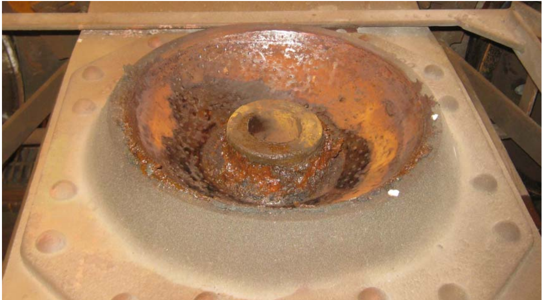
Kuva 7. Ensimmäisenä suistuneen telin telikeskiö oli suhteellisen kuiva ja hieman ruosteinen.
