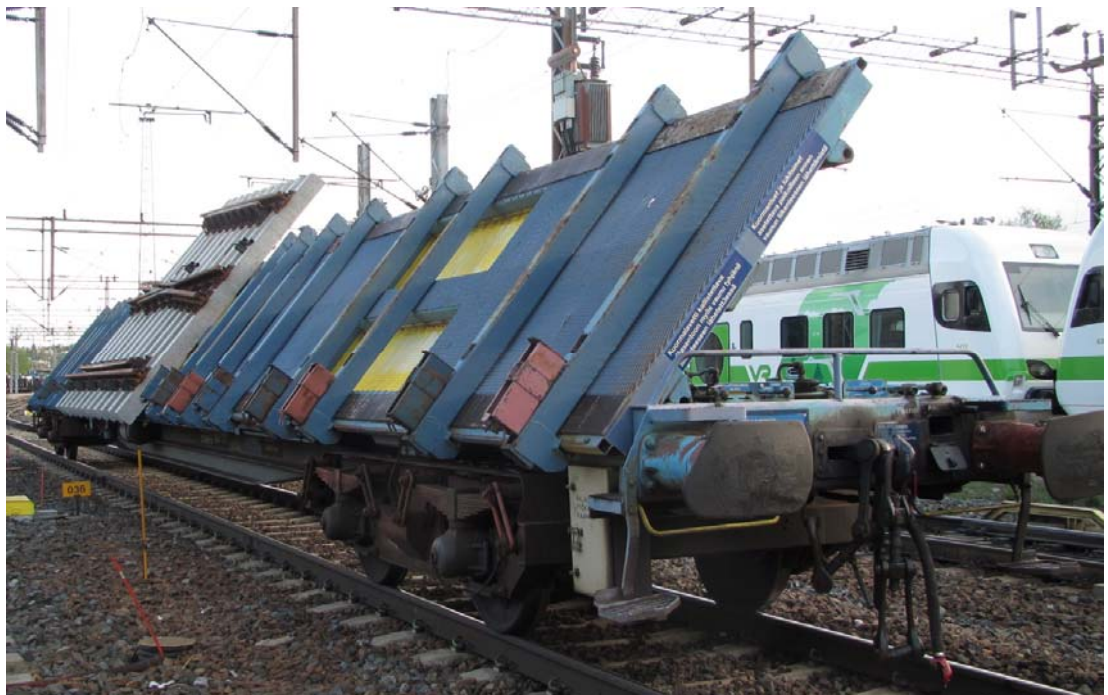
Kuva 19. BOv-vaunu kuormaustaso kallistettuna kuljetusasentoon ja kuormana on vaihteen risteuselementti. Elementti lastataan pankkojen päälle, tuetaan tuentapylväiden varaan ja kiinnitetään pölkkyistä kuormaustasoon.
