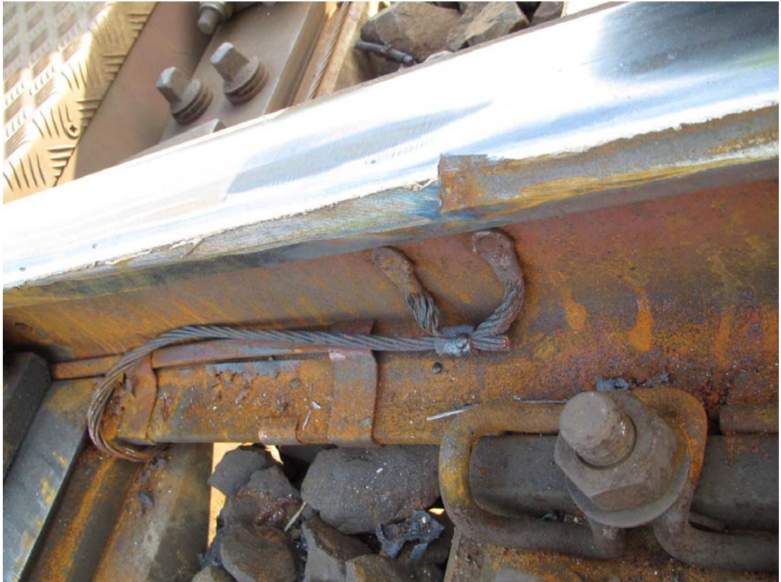
Kuva 9. Kiskossa oli lohkeama kulkureunan puolella noin puoli metriä ennen vastavaihteeseen ajetun V002 ulkokaarten puoleisen kielen kärkeä. Lohkeaman ympäristössä oli metallilastuja ja kiskossa lämmön aiheuttamia värimuutoksia. Myös kiskon hamaran profiilin muoto oli muuttunut lohkeaman ympäriltä.
