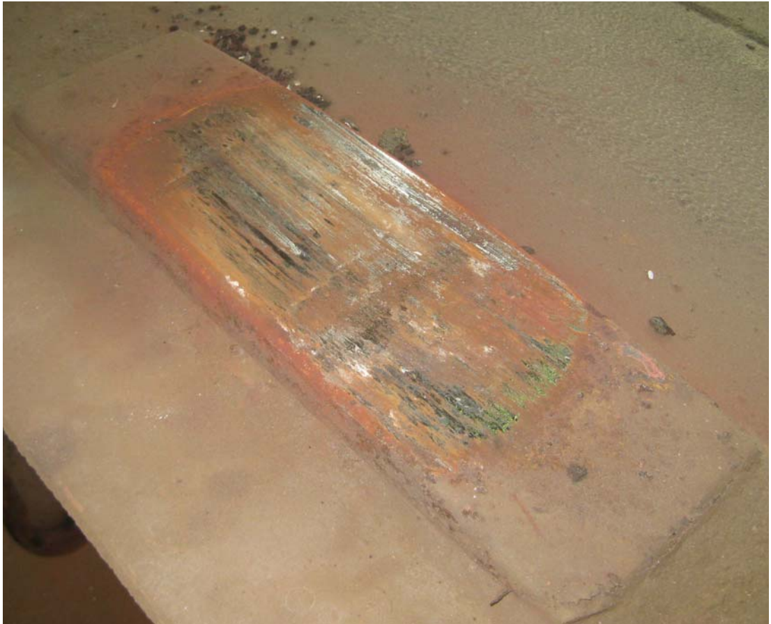
Kuva 13. Vaunun runko on nojannut voimakkaasti telin toisen puolen sivutyynyyn.
