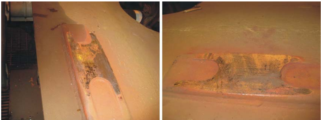
Kuva 8. Kuormaustason kallistussuunnan puoleisissa telien päällä olevissa sivutyynyissä oli merkkejä niihin kohdistuneesta suuremmasta rasituksesta verrattuna toisella puolella oleviin. Metalli oli hankautunut kiiltäväksi, kun taas sivutyynyn pinta vastakkaisella puolella oli tasaisen ruosteen peitossa.
