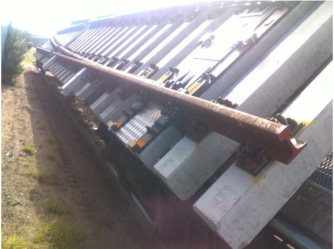
Kuva 11. Kouvolassa kaatunut vaunu valokuvattuna kuormauksen jälkeen Kaipiaisissa. Vaunuun oli kuormattuna kieli- ja välikiskoelementit. (Kuva: VR)
