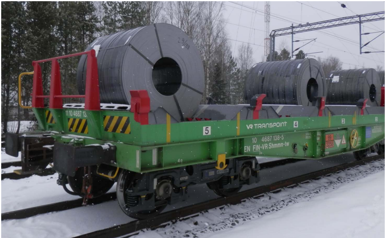
Kuva 7. Rainakelanippuja lastattuna kelavaunun kehtoihin. (Kuva: OTKES)
