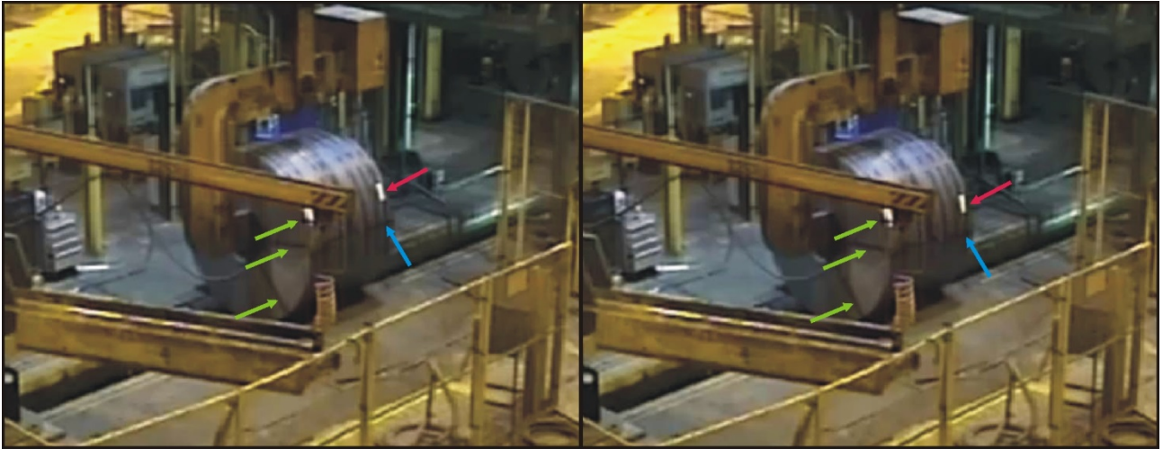
Kuva 5. Valvontakameran tallenteesta otetuista kuvakaappauksista näkyy, että rainat kiertyvät toistensa suhteen nostettaessa kelaä sidontapaikalta varastoalueelle. Eniten kiertyy kuvassa kauimmaisena oleva raina. Kiertymisen voi havaita valkoisesta tarrasta (punainen nuoli) sekä rainoja yhdessä pitävästä silmävanteesta (sininen nuoli). Kameraa lähimpänä olevan puolen kohdat (vihreät nuolet) pysyvät paikoillaan. Onnettomuudessa junasta pudonnut raina oli kuvassa kauimmaisena oleva. (Kuva: OTKES, SSAB:n kameratallenteelta)
