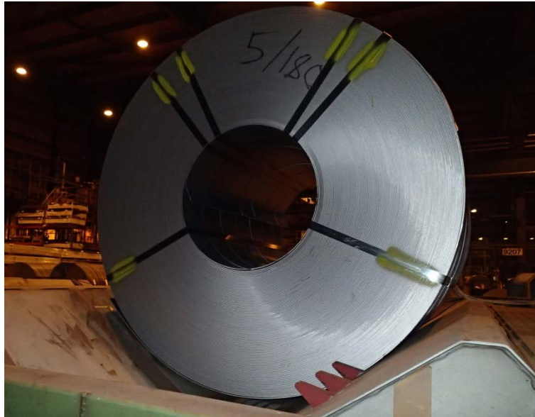
Kuva 15. Muutettu silmäsidontatapa (Kuva: OTKES)
