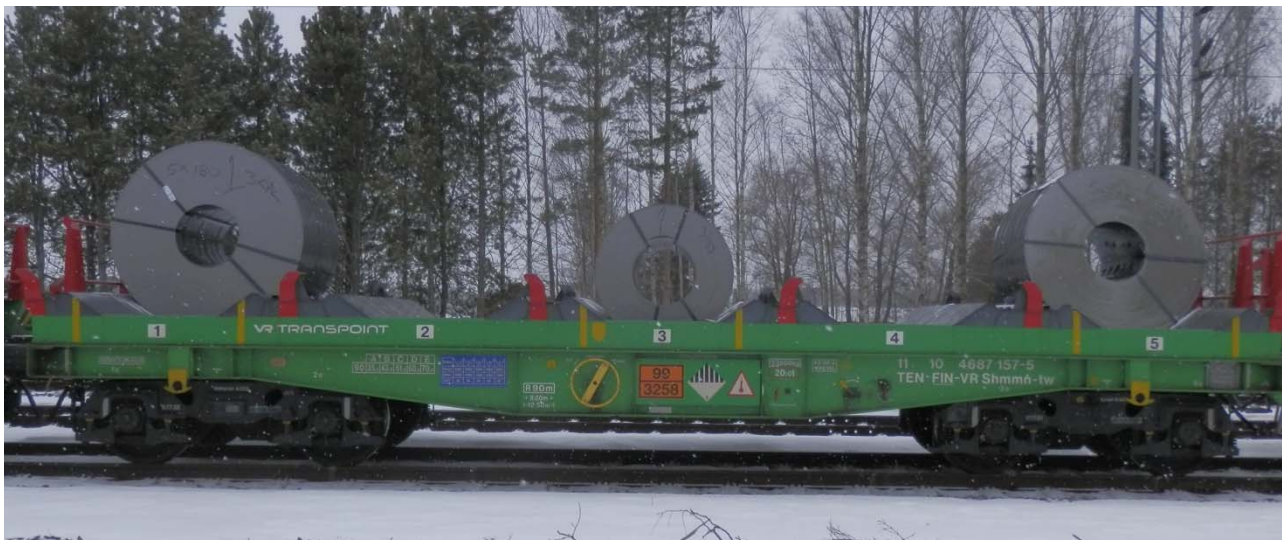
Kuva 14. Kelojen silmävanteiden paikkoja havainnollistava kuva. Päädyissä olevissa keloissa keskilinjan yläpuoliseen osaan jää isommat ilman silmävanteita olevat sektorit. Keskimmäisen pienemmän kelanipun toiset silmävanteet ovat symmetrisesti yläsektorissa ja tukevat näin nippua paremmin. (Kuva: OTKES)
