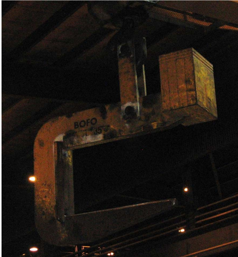
Kuva 4. Siltanosturissa käytettävä C-koukku, jolla kelat nostetaan. (Kuva: OTKES)
