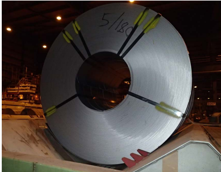
Kuva 15. Muutettu silmäsidontatapa (Kuva: OTKES)
