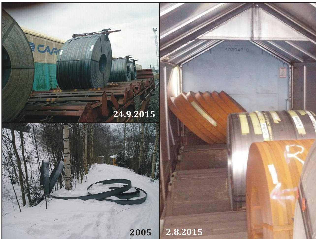
Kuva 9. Aikaisempia tapauksia, joissa rainakelanippu on kallistunut kuljetuksen aikana tai rainakela pudonnut. (Kuvat: VR)
