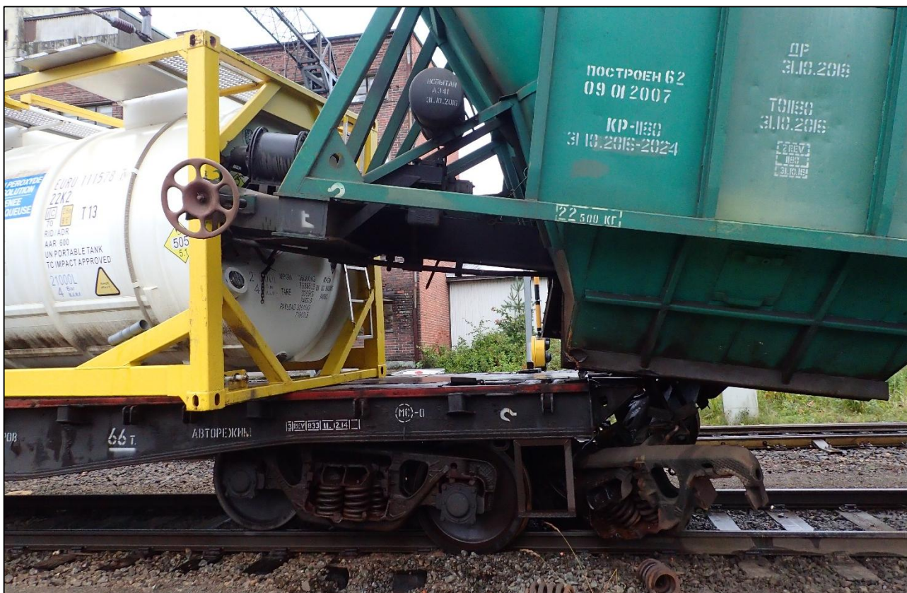
Kuva 9. Siilovaunun ja konttivaunun törmäyskohta. Siilovaunun vaurioitunut teli on osin konttivau- nun päädyn alla ja konttivaunun ensimmäinen pyöräkerta on suistunut kiskoilta. (Kuva: OTKES)
