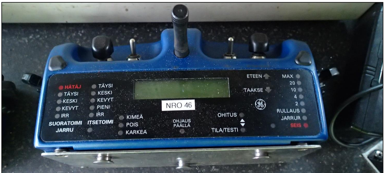
Kuva 17. GE Transportation Systems LOCOTROL-järjestelmän radio-ohjain, OCU, jolla tavallisella vaihtotyöyksikköä ohjattiin onnettomuushetkellä. Ohjaimen vasemman reunan säätimellä ohjataan jarrutusta ja oikean reunan säätimellä veturin nopeutta. Hätäjarrutus tehdään kääntämällä ohjaimen vasemman reunan säädin täysin eteen. (Kuva: OTKES)
