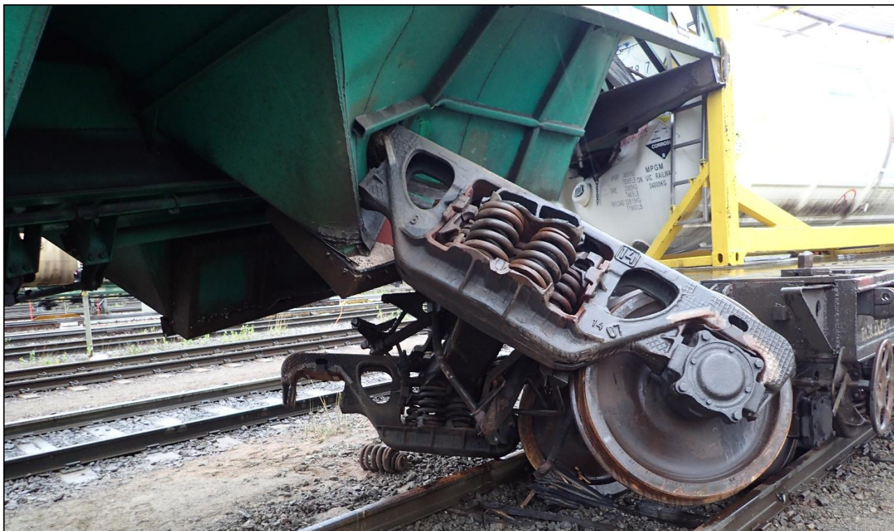
Kuva 10. Siilovaunun ja konttivaunu törmäyskohta toiselta puolelta. Siilovaunun vaurioitunut teli on noussut kiinni vaunun pohjaluukkuun. Vaurioitunut ratapölkky näkyy myös kuvassa. (Kuva: OTKES)
