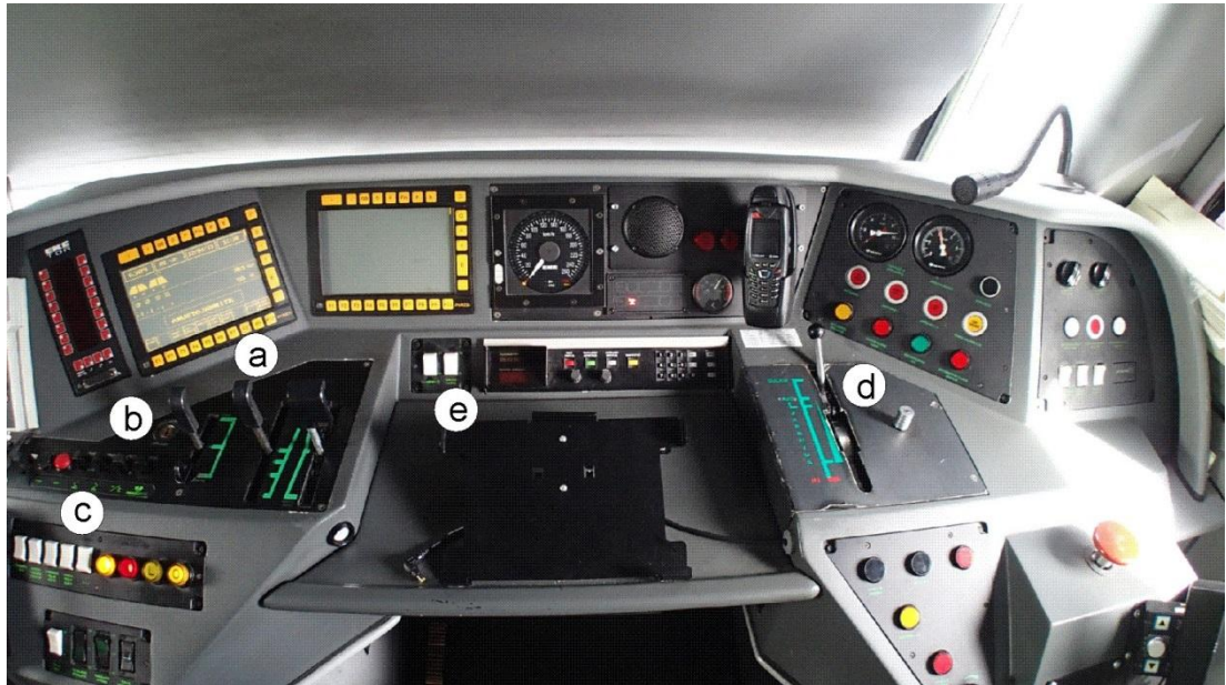
Kuva 9. Kuvassa Sm4-junan ajopöytä hallintalaitteineen: a) monitori b) virtalukko c) ajopöydän kytkimet (vasemmalta ohjauspiirit, PK kiinni, PK auki, takimmainen virroin, etummainen virroin, apukäyttöinvertteri ja kompressorin pakkokäyttö), d) jarrukahva ja e) valonheittimen kytkin.
