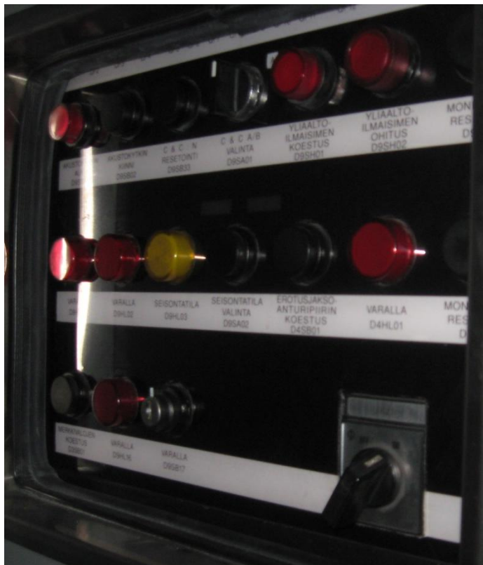
Kuva 10. JKV kytkin sijaitsee ohjaustaulussa ohjaamon oven vieressä.
