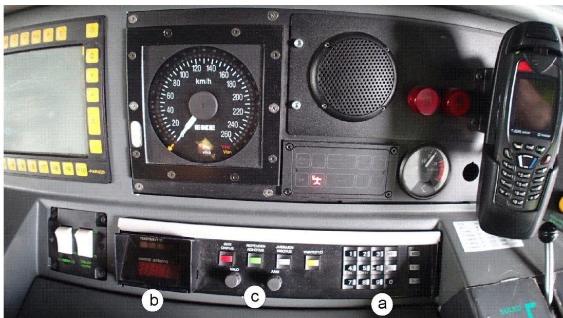
Kuva 6. Junan kulunvalvonnan paneeli sijaitsee nopeusmittarin alapuolella. Sen avulla kuljettaja syöttää JKV-järjestelmälle tarvittavat junatiedot käyttäen oikeassa reunassa olevia näppäimiä (a). Paneelin näyttö (b) antaa myös junan liikkuesa kuljettajalle tietoa tulevista opasteista ja nopeusrajoituksista. Kuljettajalla on mahdollisuus valo- ja äänipotentiometrin (c) avulla säätää näytön valaistusta ja äänisignaalin voimakkuutta.
