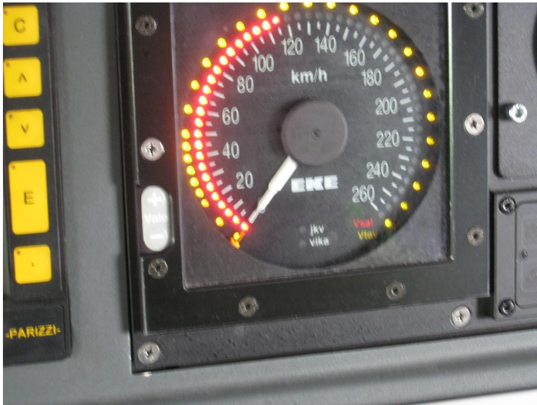
Kuva 5. Sm4-junan nopeusmittari JKV:n alkutestauksen aikana. Keltainen LED-kehä näyttää veturinkuljettajalle junan tavoitenopeuden (Vtav) ja punainen LED-kehä junan sallitun nopeuden (Vsal). Nopeusmittarin neulan kohdalla on lisäksi näkyvissä mittarin ulkokehälle sijoitettu nopeuden säädön nuoli, joka liikkuu kuljettajan säätäessä junan nopeutta.
