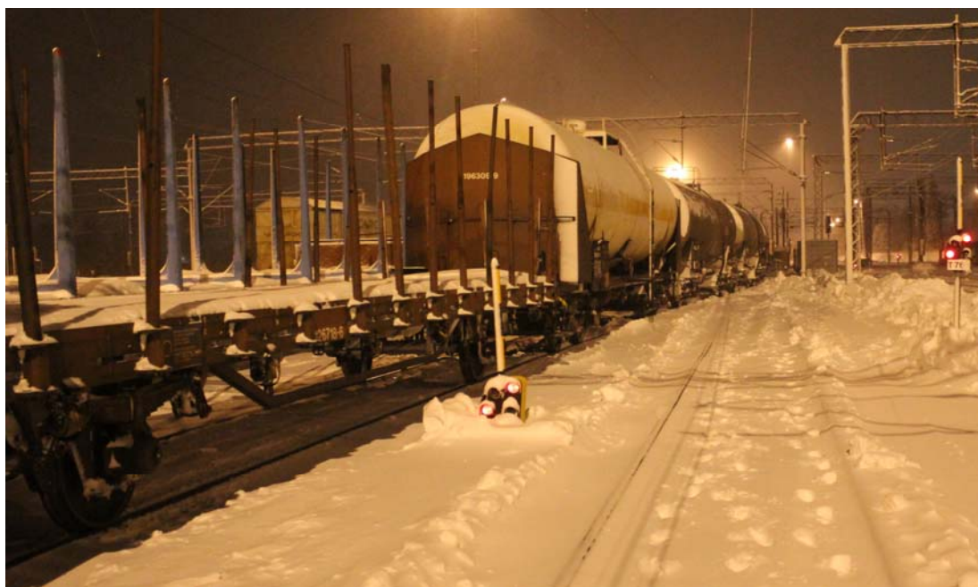
Kuva 3. Onnettomuusjuna lähti kuvan keskellä olevan raiteen 763 länsipään raideopastimen kohdalta. Juna suistui toisen säiliövaunun kohdalla olevassa vaihteen risteyksessä.
