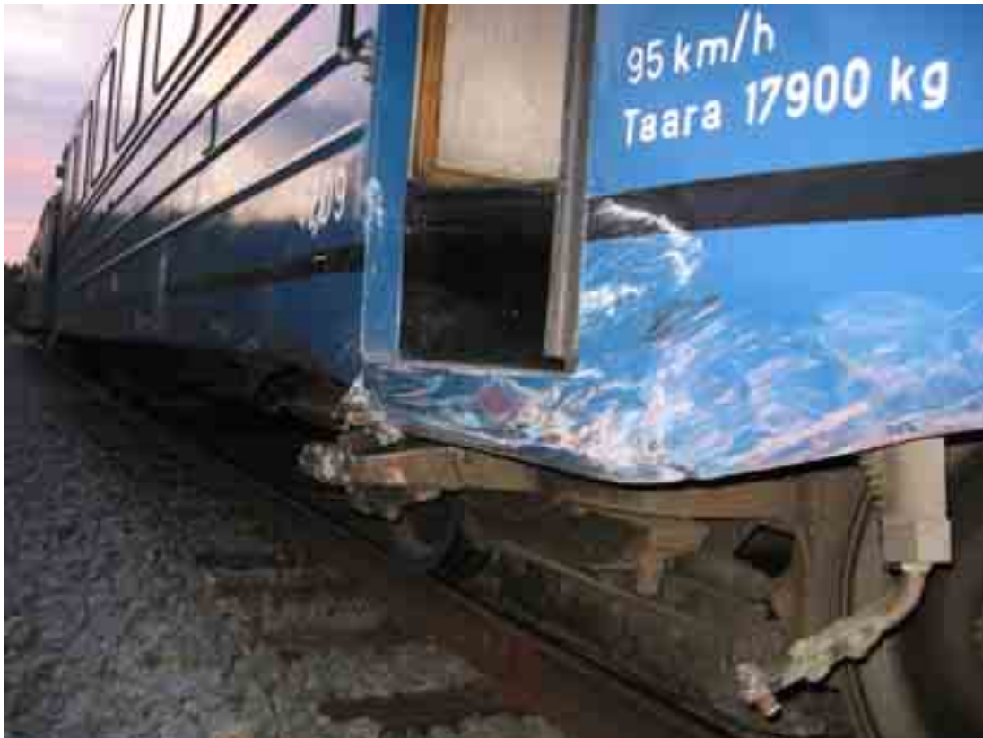
Kuva 29. Moottorivaunun vaurioitunut etukulma (kuva poliisi).
