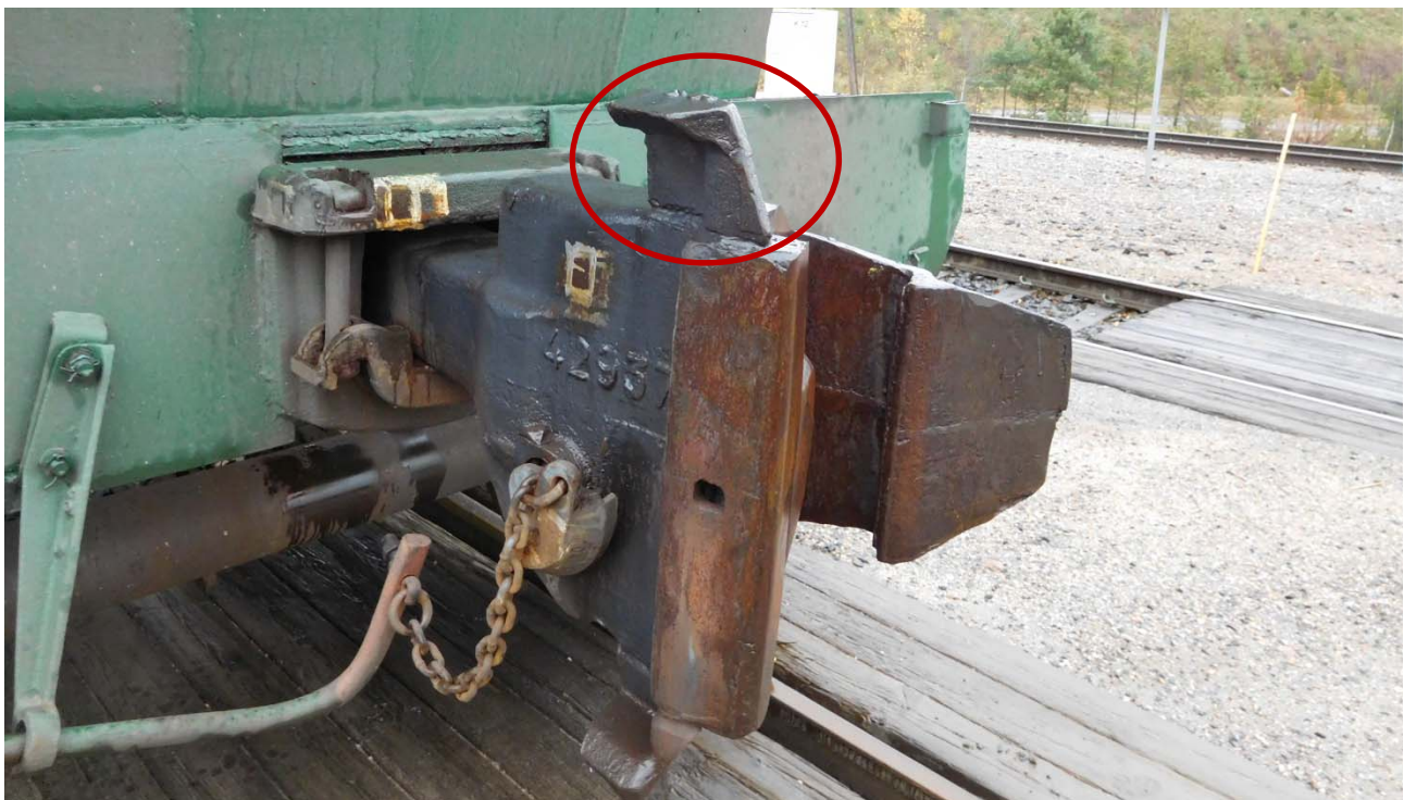
Kuva 4. Ylisyoksynestimellä varustettu SA3-kytkin. (Kuva: OTKES)
