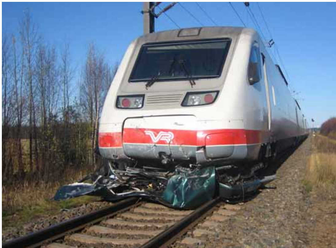
Kuva 4. Henkilöauto romuttui törmäyksessä täysin ja raahautui Pendolino-junan keulan alla lähes 600 metriä.
