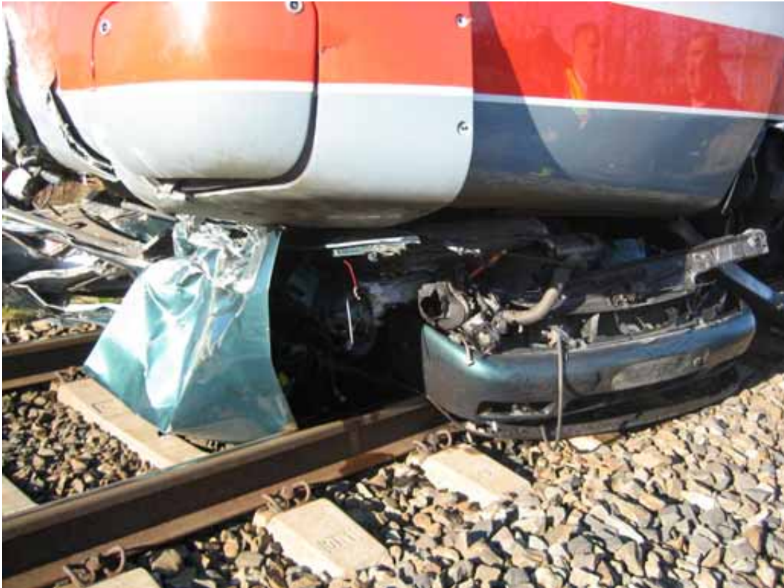
Kuva 8. Pendolinon keulan vasen puoli nousi ylöspäin alle kiilautuneen auton takaosaa vahvemman etuosan nostamana.
