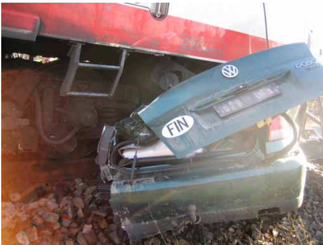
Kuva 7. Onnettomuudessa veturin etuosan muotoiltu alaosa rikkoutui ja henkilöauto kii-lautui täysin veturin keulan alle, takaosa etuteliin saakka.
