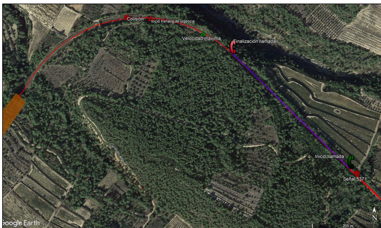
Imagen 16 En azul aparece el trayecto del tren 55203 en el que su maquinista estuvo en comunicación con el RC del CTC. Se aprecia que es anterior a la zona en curva.
