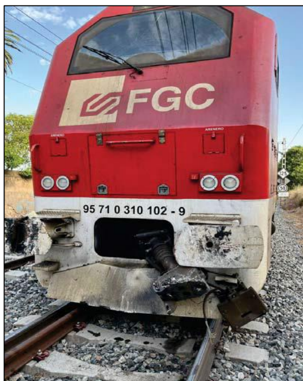
Figura 3 Daños en el tren 95172 tras el impacto
