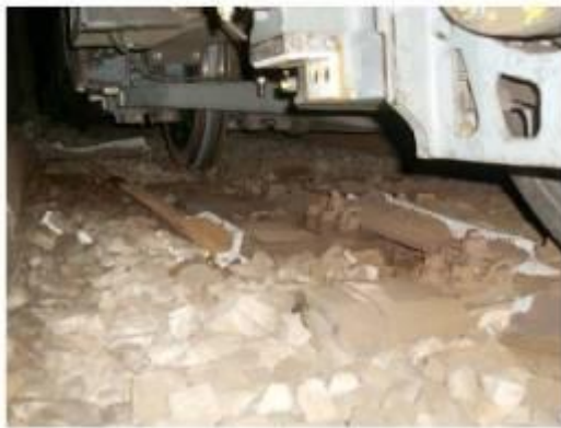
PUNTO "0" DEL DESCARRILAMIENTO. RUEDA IZQUIERDA DEL CUARTO EJE DE LA MOTRIZ DE COLA. Fuente Adif
