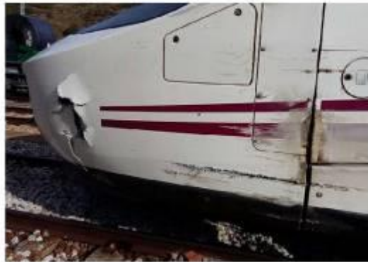
DETALLE DE LOS DESPERFECTOS SUFRIDOS POR LA MOTRIZ DE CABEZA AL ROZAR CON EL HASTIAL DEL TÚNEL. Fuente Adif
