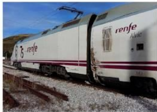
DETALLE DE LOS DESPERFECTOS SUFRIDOS POR LA MOTRIZ DE CABEZA AL ROZAR CON EL HASTIAL DEL TÚNEL. Fuente Adif
