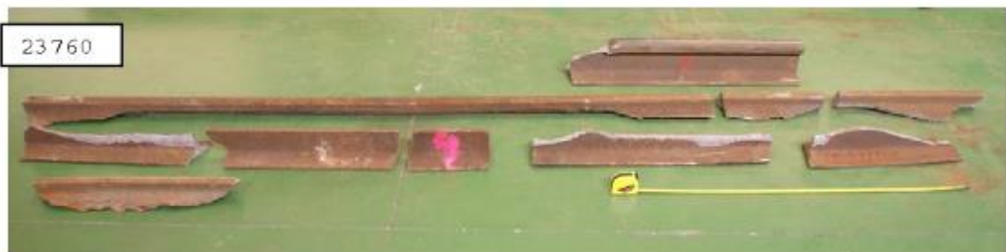
FRAGMENTOS DE LA ROTURA ANALIZADOS EN EL LABORATORIO. Fuente Adif
