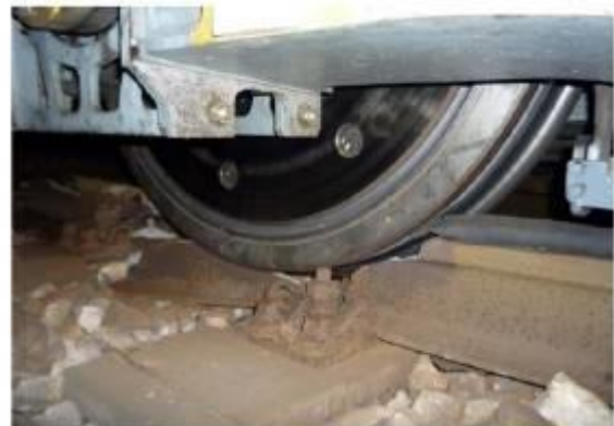
PUNTO "0" DEL DESCARRILAMIENTO. RUEDA IZQUIERDA DEL CUARTO EJE DE LA MOTRIZ DE COLA. Fuente Adif
