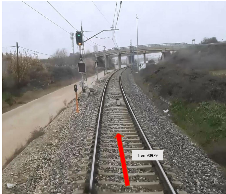
Señal nº 29 avanzada de la estación de Lleida-Pirineus. En el momento del suceso ordenaba parada. Fuente Adif.
