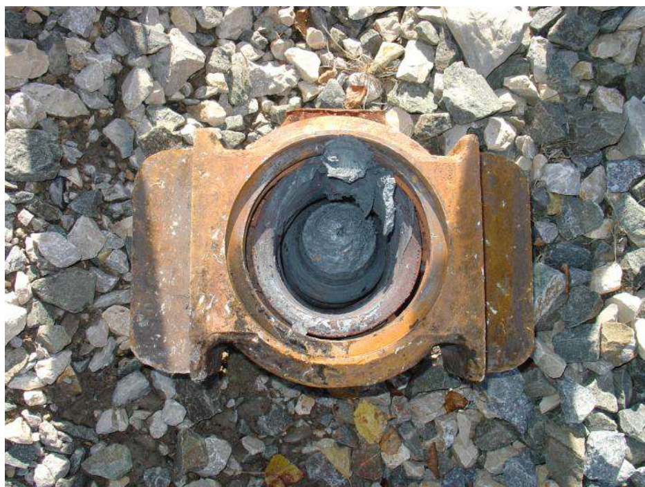
Caja de grasa derecha del 2º eje del vagón 24 (437141795314) con parte de la mangueta del eje.
