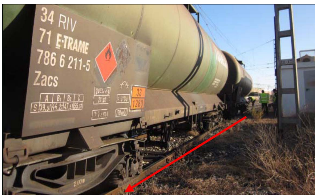
Vista de los vagones 4º y 5º descarrilados (lado izquierdo según el sentido de la marcha) (Fuente: Adif)
