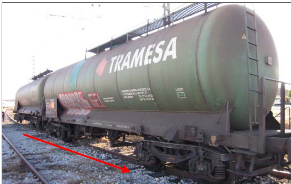
Vista de los vagones 4º y 5º descarrilados (lado derecho según el sentido de la marcha) (Fuente: Adif).
