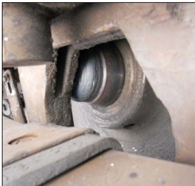
Vista de la rotura de la mangueta de la rueda derecha del segundo eje según el sentido de la marcha. Se observa la caja de grasa desprendida. Fuente Adif
