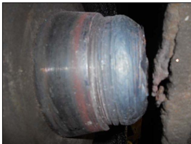
Vista de la rotura de la mangueta de la rueda derecha del segundo eje según el sentido de la marcha. Se observa la caja de grasa desprendida. Fuente Adif
