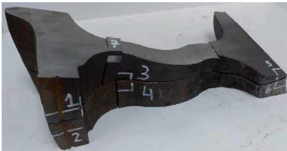
Probetas para el estudio metalográfico (fuente: ETSII Madrid)
