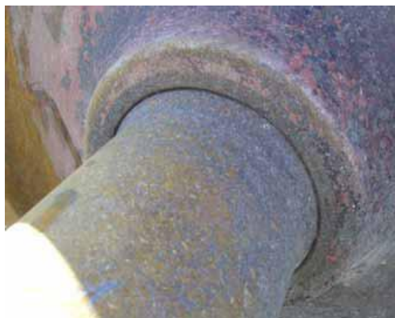
Decalado de la rueda derecha del segundo eje del primer bogie.
