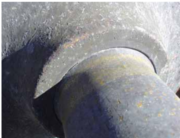
Decalado de la rueda derecha del segundo eje del primer bogie.
