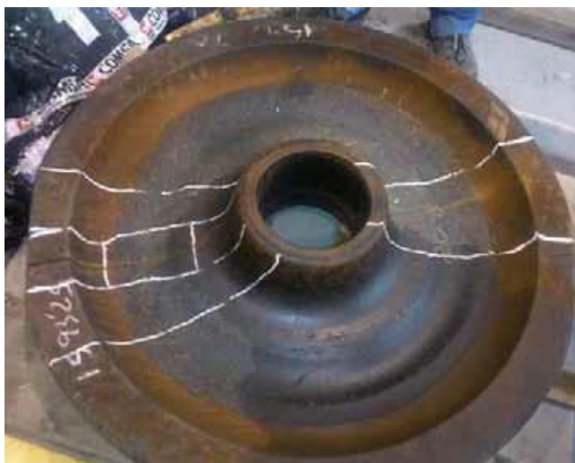
Marcas de tiza sobre las zonas a cortar de la rueda para obtener probetas (fuente: ETSII Madrid)
