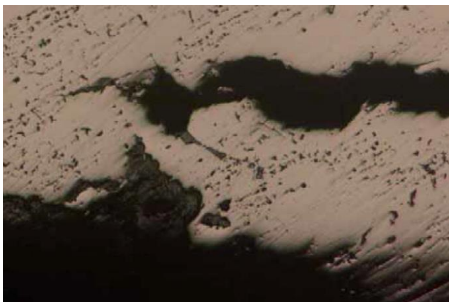
Fotomicrografía 10 X50. Probeta 5 zona grieta (fuente: ETSII Madrid)
