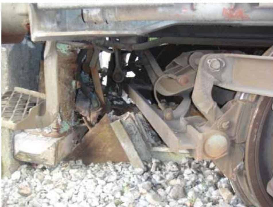
Detalle de los daños en el vagón descarrilado 327128508386
