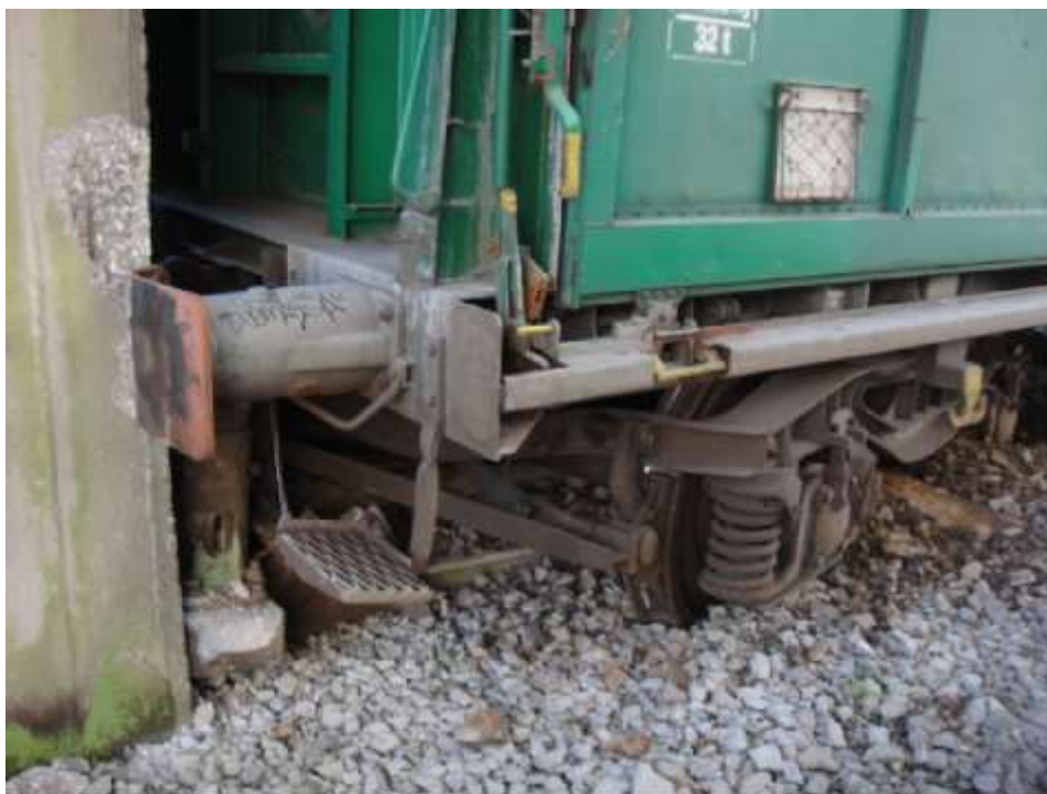
Detalle de los daños en el vagón descarrilado 327128508386
