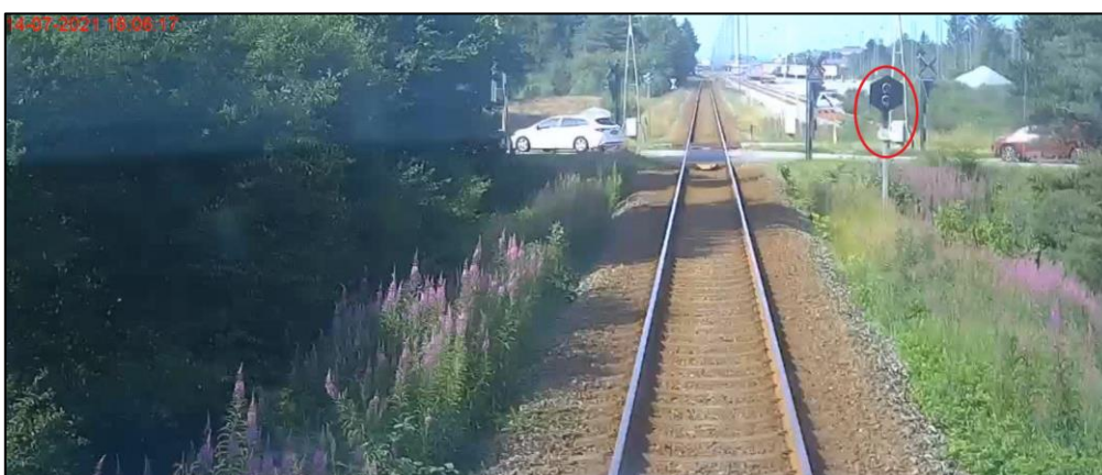
Figur 6. Optagelse fra togets frontkamera kort før passage af overkørslen, overkørselssignalet der er placeret til højre for sporet står 22 meter før overkørslen. Signalet er slukket. Overkørselens 4 bomme er alle oppe. Der var flere biler, der passerede overkørslen kort før kollisionen.
