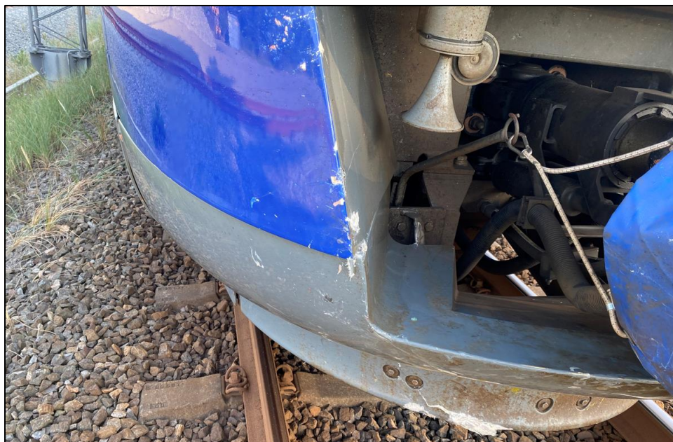
Foto 8. Skader og mærker på togets front efter påkørsel.
