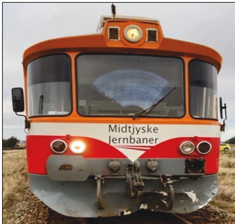
Foto 6: D. 18-01-2022, togets front med skader på banerømmer og venstre puffer mangler. Kilde: MJBA.
