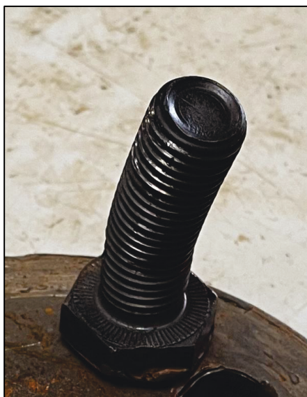
Foto 3. Skrue af Verbus Ripp typen. (Her fotograferet efter hændelsen maj 2021. Kilde: NJ.
