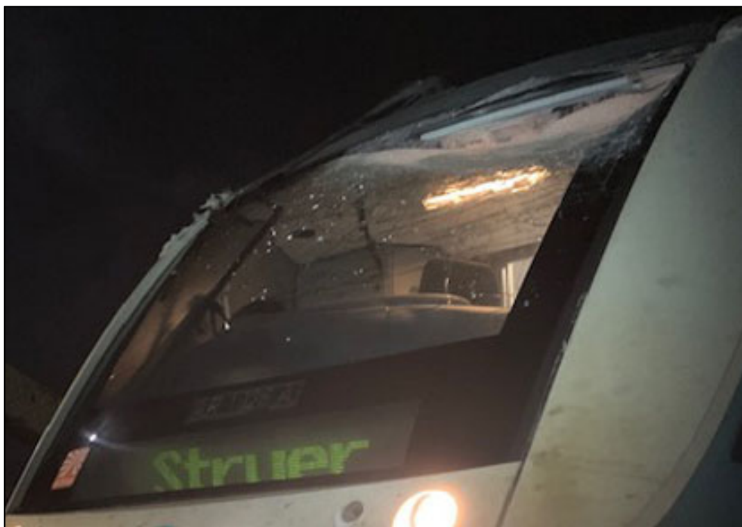
Foto 2 Skader på fronten af togsættet - det ses hvor bunden af kurven har ramt.
