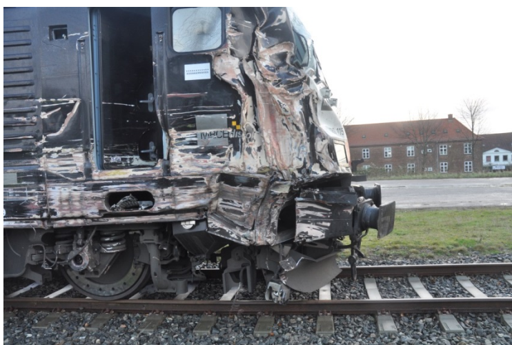
2 Skader på fronten af Dispolok 189-115
