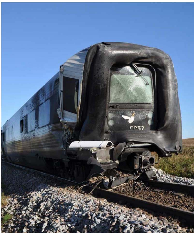
Foto 9 Den skadede front og undervogn på MF 5037
