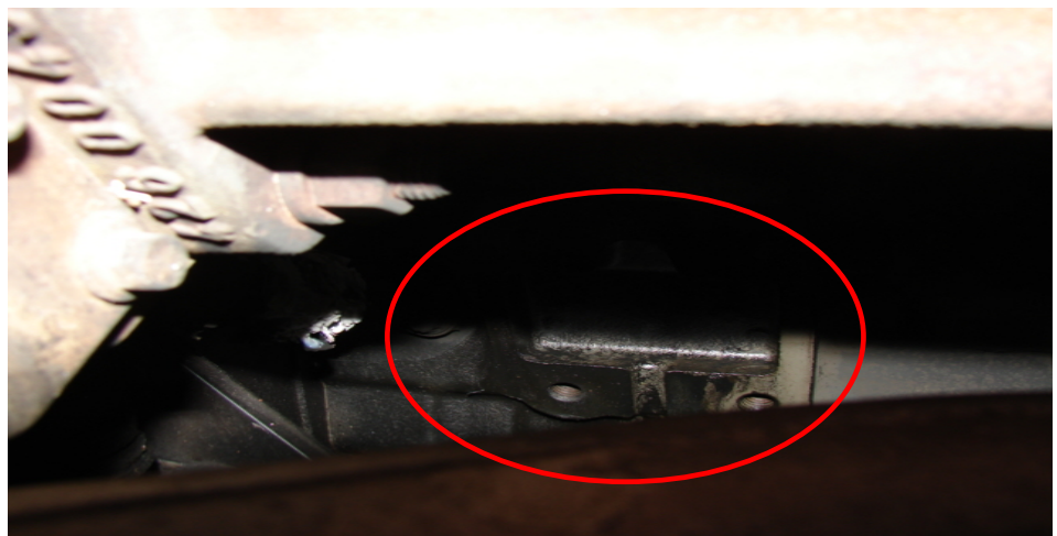
Foto 7: Spor af lækage af dieselolie på motorblok
