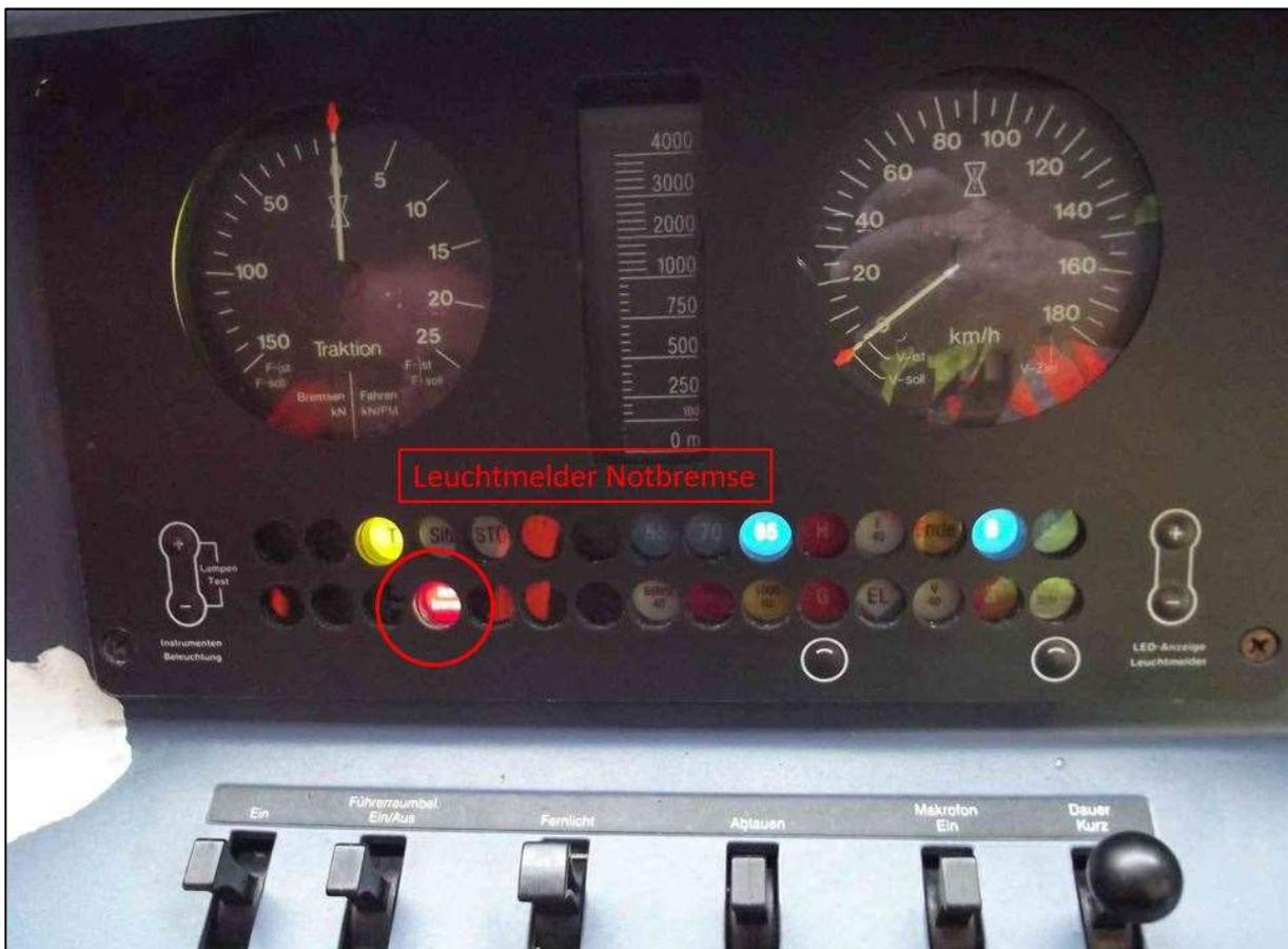
Abbildung 7: Leuchtmelder Notbremse auf MFA im Führerstand mittig
