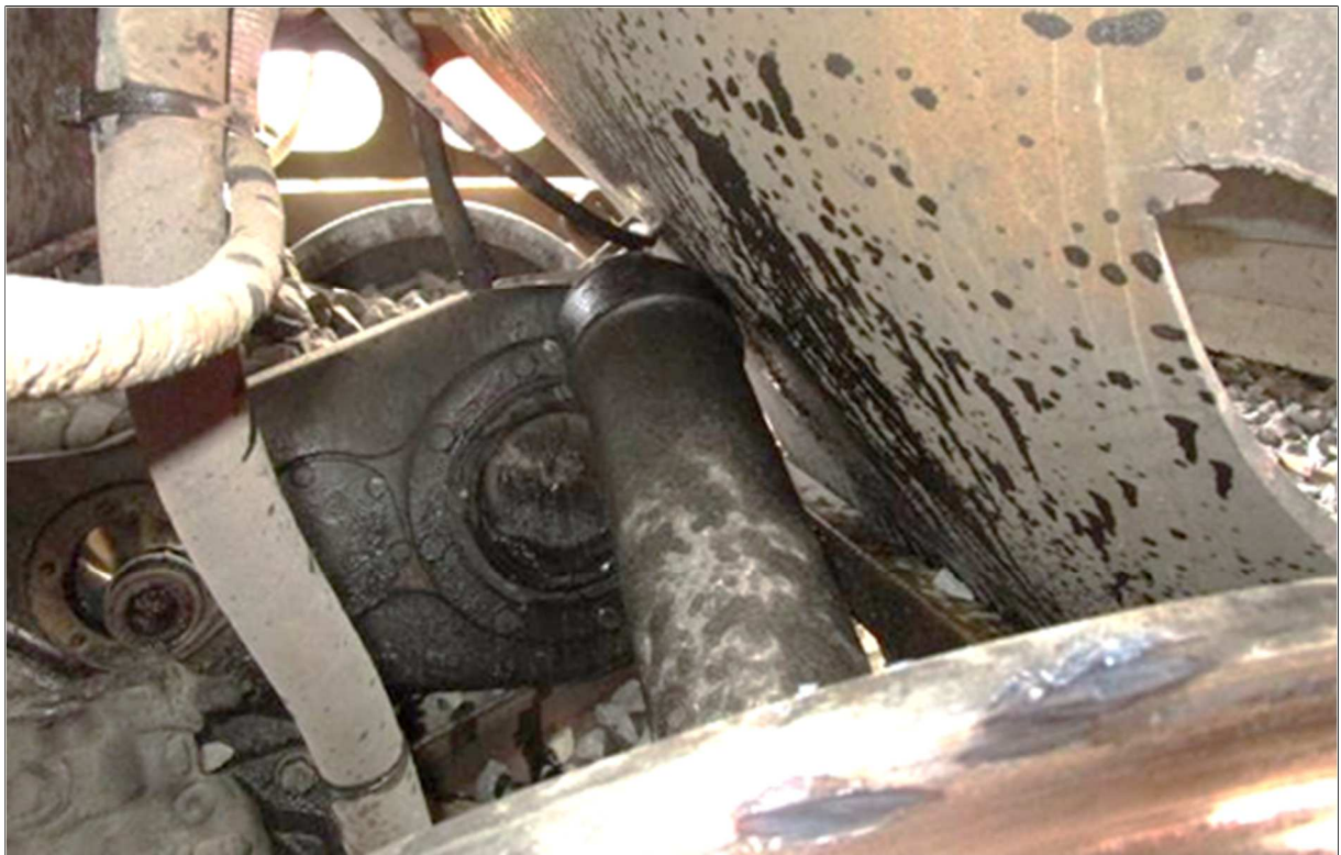
Abbildung 4: Gebrochene hintere Treibradsatzwelle
